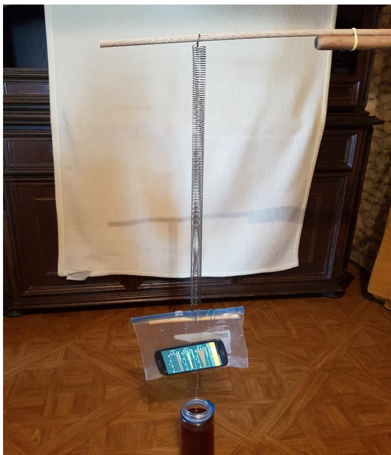
Slika 33: Eksperimentalni postav za prigušeno titranje u tekućini
