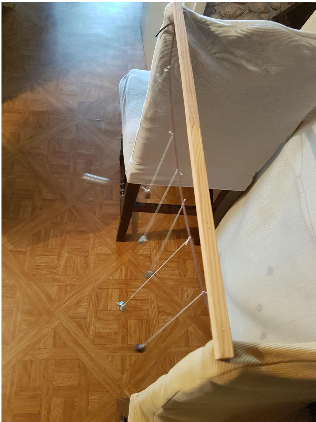
Slika 43: Njihala jednake duljine titraju najvećom amplitudom
