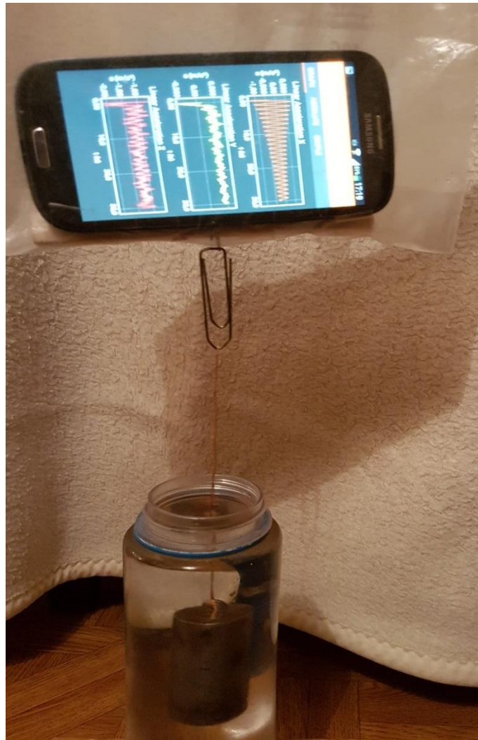
Slika 36: Prigušenje titranja u vodi
