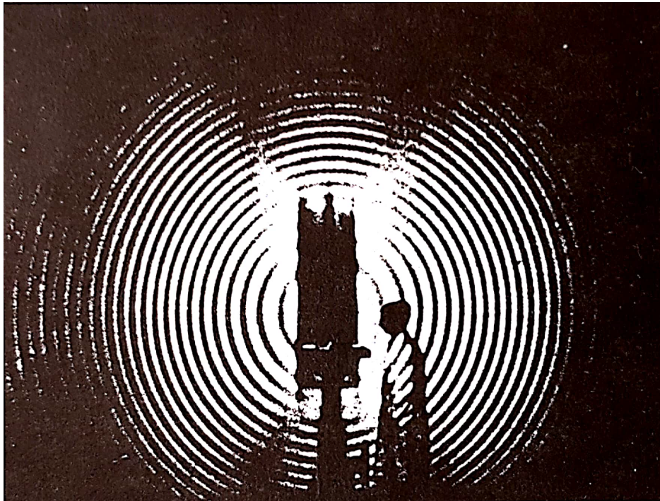
Slika 3.2: Pohlov eksperiment interferencije svjetlosti pomoću planparalelnih zrcala od liskuna. [4]
