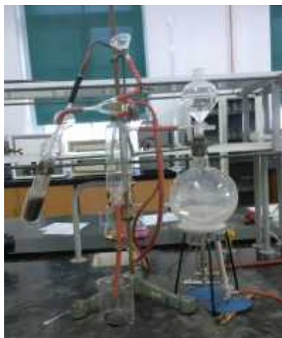
Slika 23. Aparatura za destilaciju
