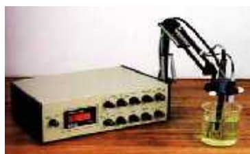
Slika 18. Laboratorijski ph- metar
