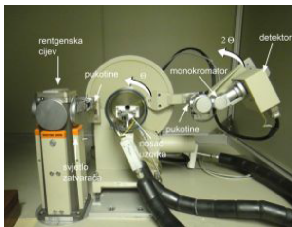
Slika 16: Rendgenski difraktometar u laboratoriju fizičkog odsjeka PMF-a u Zagrebu.
