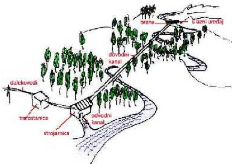
**Slika 2.** Princip sustava male hidroelektrane (<http://hr.wikipedia.org/wiki/hidroelektrane>)
