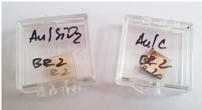
Slika 4.1. Mete ^{\text{nat}}\text{SiO}_2 i ^{12}\text{C} s naparenim slojem zlata korištene u eskperimentu.
