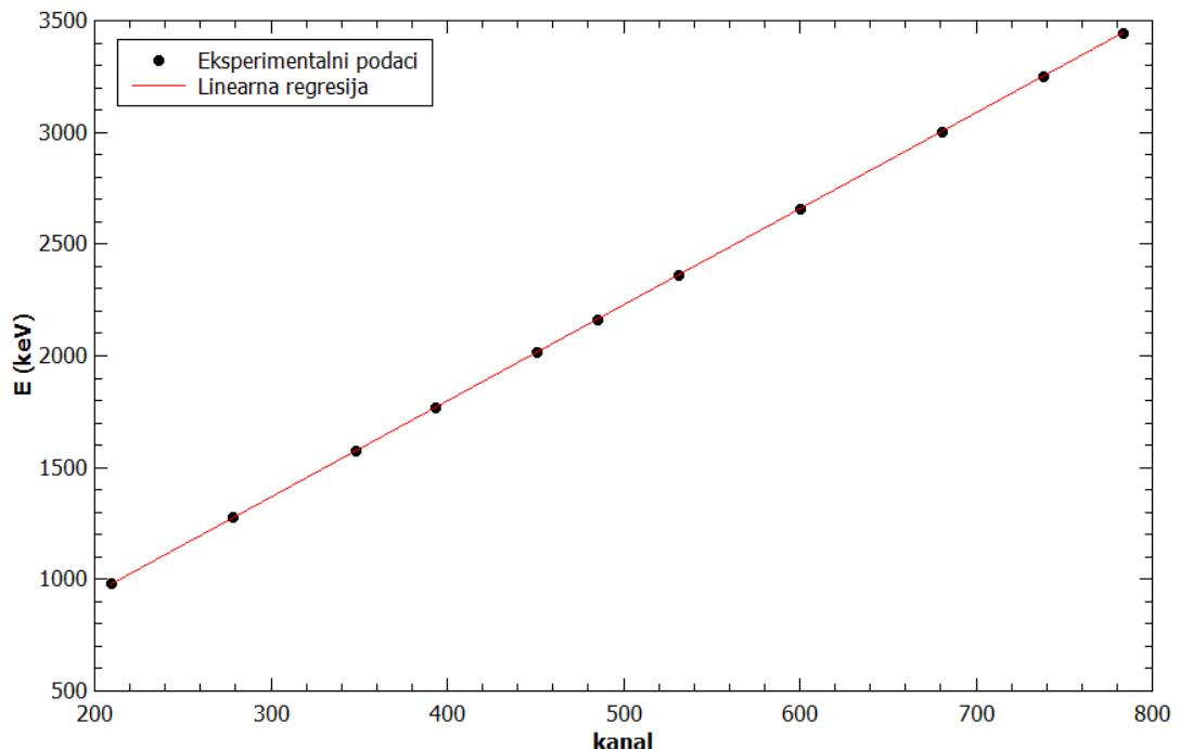
**Slika 6.3.** Kalibracija energije za kut od  $165^\circ$
