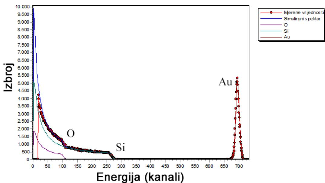
Slika 4.3. Eksperimentalni spektar raspršenja iona  ${}^7\text{Li}^{2+}$  na meti  $\text{Au}/{}^{\text{nat}}\text{SiO}_2$
