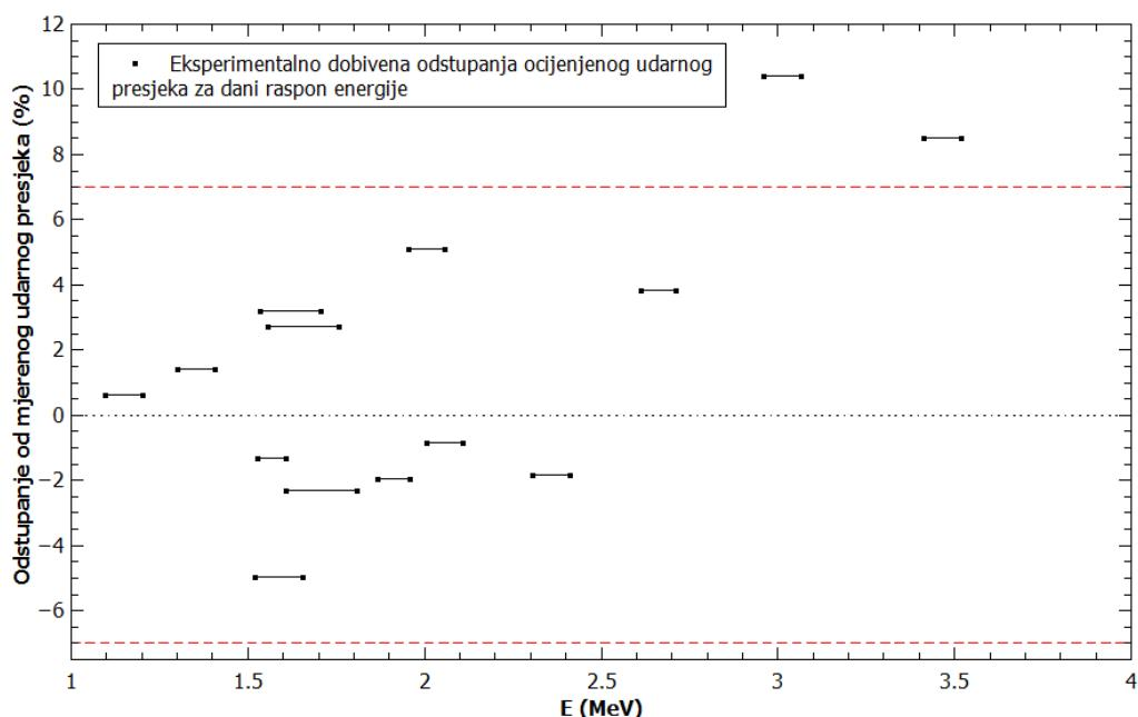
**Slika 6.6.** Grafički prikaz odstupanja ocijenjenog udarnog presjeka za raspršenje protona na  $^{12}\text{C}$  za kut raspršenja  $150^\circ$
