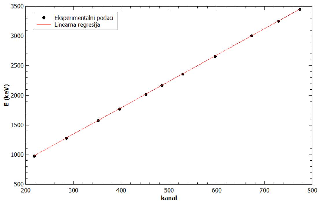
**Slika 6.2.** Kalibracija energije za kut od  $150^\circ$
