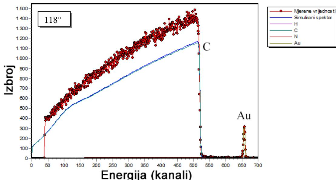
**Slika 6.8.** Primjer spektra kod kojeg je vidljivo neslaganje mjerjenih podataka s ocijenjenim. Radi se o  $^{12}\text{C}(\text{p},\text{p})^{12}\text{C}$  reakciji gdje je energija protona 3.065 MeV, a kut raspršenja  $118^\circ$ . Odstupanje iznosi 17%.
