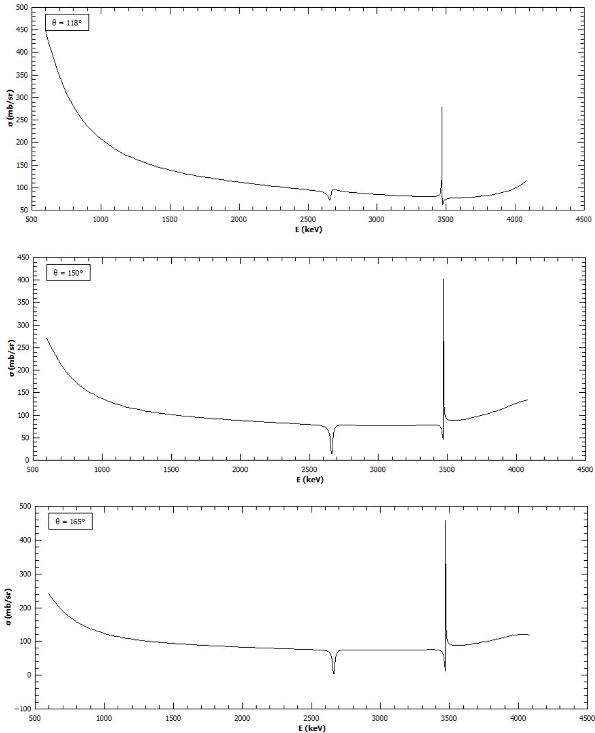
**Slika 2.12 .** Vrijednosti diferencijalnog udarnog presjeka za  $^{16}\text{O}(\text{p},\text{p})^{16}\text{O}$  reakciju u ovisnosti o energiji upadnog protona za kutove raspršenja  $118^\circ$ ,  $150^\circ$  i  $165^\circ$ .
