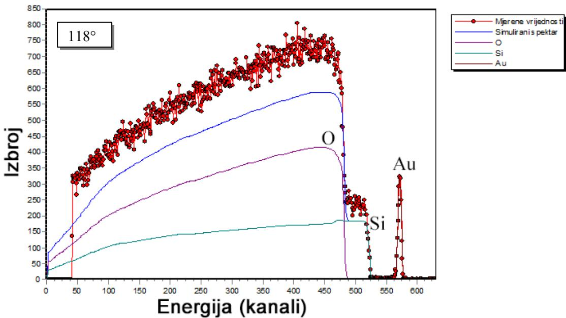
**Slika 6.20.** Primjer spektra kod kojeg je vidljivo neslaganje mjerenih podataka sa ocijenjenjem. Radi se o  $\text{o}^{16}\text{O}(\text{p},\text{p})\text{o}^{16}$  reakciji gdje je energija protona 2.662 MeV, a kut raspršenja  $118^\circ$ . Odstupanje iznosi 17%.
