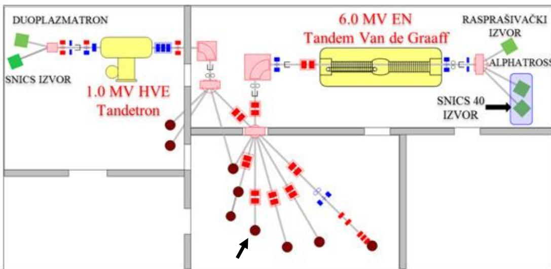
**Slika 3.1.** Shema ubrzivačkog sustava Laboratorija za interakciju ionskih snopova Institutu Ruđer Bošković. Crnim strelicama označeni su eksperimentalna linija koja je korištena u eksperimentu i ionski izvor.
