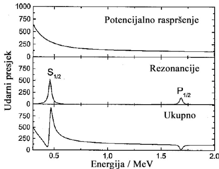
**Slika 2.3.** Interferencija potencijalnog i rezonantnog raspršenja za  $^{12}\text{C}(\text{p},\text{p})^{12}\text{C}$  reakciju. Preuzeto iz [1].
