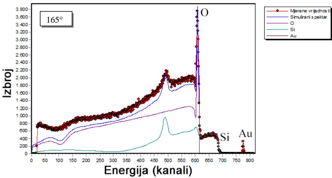
**Slika 6.22.** Primjer spektra kod kojeg je vidljiv vrh događaja koji dolaze od rezonancije. Radi se o  $^{16}\text{O}(\text{p},\text{p})^{16}\text{O}$  reakciji gdje je energija protona 3.487 MeV, a kut raspršenja  $165^\circ$ . Odstupanje iznosi 7.9%.
