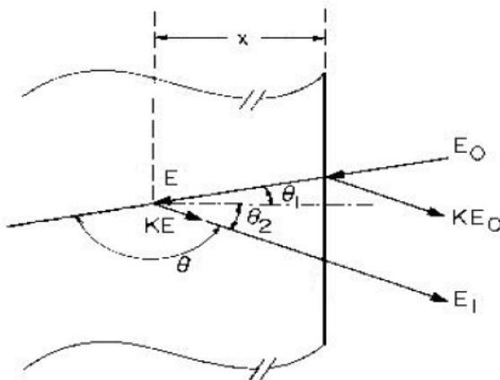
**Slika 2.5.** EBS raspršenje na monoizotopnoj meti, gdje je  $\theta_1$  kut upadnog snopa, a  $\theta_2$  kut raspršenja s obzirom na normalu mete. Upadni snop, smjer detekcije i normala mete leže u istoj ravnini. Preuzeto iz [5].
