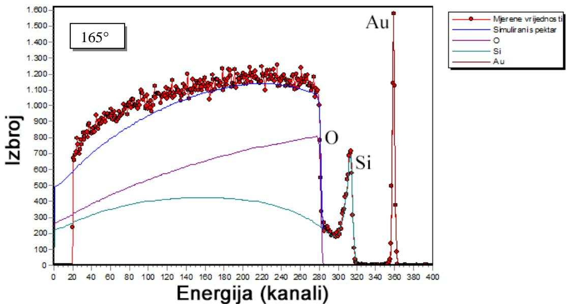
**Slika 6.16.** Primjer spektra kod kojeg je vidljiv vrh događaja koji dolaze od rezonancije. Radi se o  $^{nat}\text{Si}(p,p)^{nat}\text{Si}$  reakciji gdje je energija protona 1.655 MeV, a kut raspršenja  $165^\circ$ . Odstupanje iznosi 4 %.
