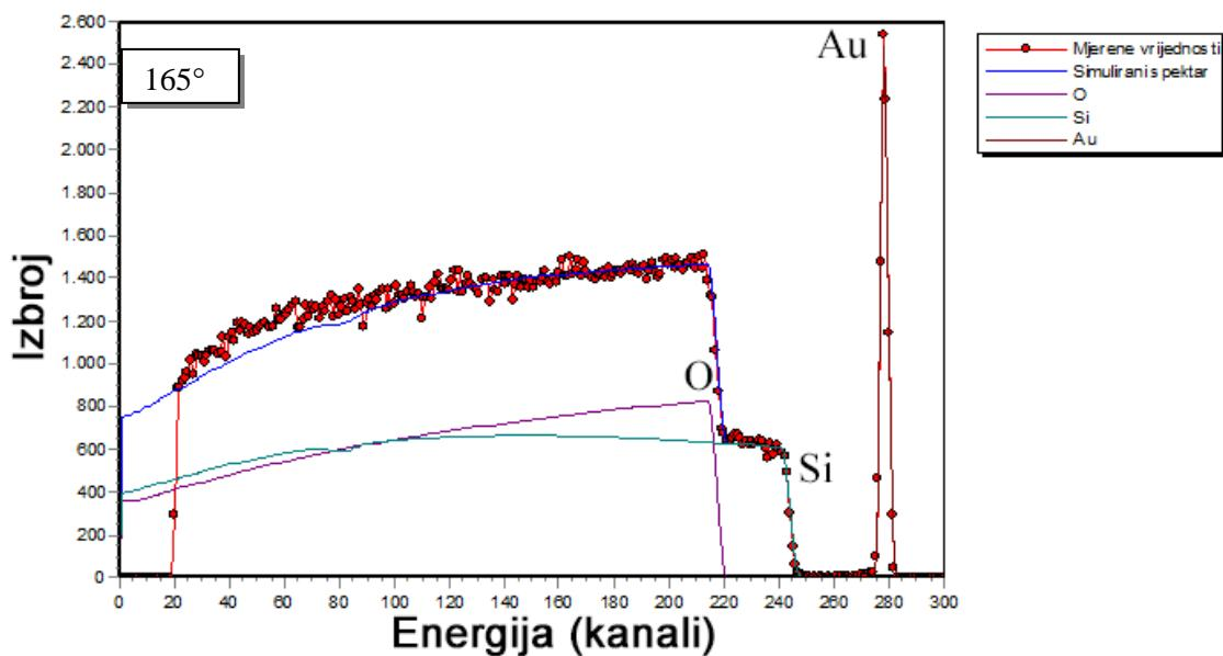
**Slika 6.21.** Primjer spektra kod kojeg je vidljivo dobro slaganje mjerenih i ocijenjenih podataka. Radi se o  $\text{o}^{16}\text{O}(\text{p},\text{p})\text{o}^{16}$  reakciji gdje je energija protona 1.304 MeV, a kut raspršenja  $165^\circ$ . Odstupanje iznosi 0.03%.
