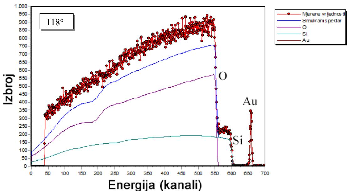
**Slika 6.14.** Primjer spektra kod kojeg je vidljivo neslaganje mjerenih podataka s ocijenjenim. Radi se o  ${}^{\text{o}}\text{Si}(\text{p},\text{p}){}^{\text{nat}}\text{Si}$  reakciji gdje je energija protona 3.0645 MeV, a kut raspršenja  $118^\circ$ . Odstupanje iznosi 21.73%.
