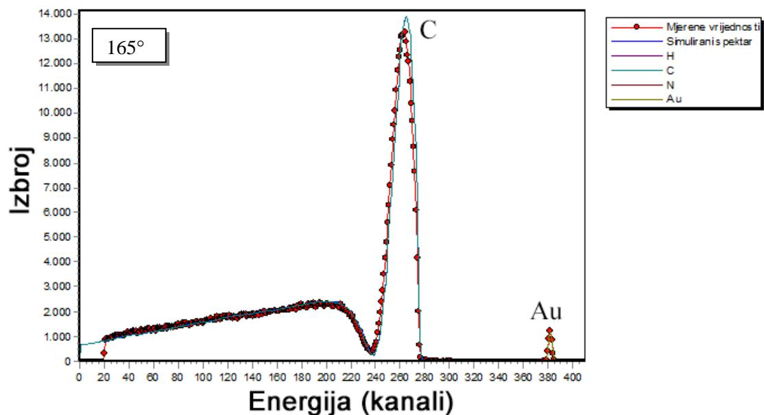
**Slika 6.10.** Primjer spektra kod kojeg je vidljiv vrh događaja koji dolaze od rezonancije. Radi se o  $\text{o}-\text{C}(\text{p},\text{p})\text{C}$  reakciji gdje je energija protona  $1.756 \text{ MeV}$ , a kut raspršenja  $165^\circ$ . Odstupanje iznosi  $-2.5\%$ .
