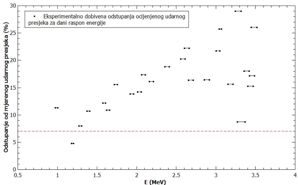
Slika 6.11. Grafički prikaz odstupanja ocijenjenog udarnog presjeka za raspršenje protona na  $^{nat}Si$  za kut raspršenja  $118^\circ$
