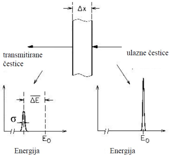
**Slika 2.4.** Monoenergetski snop iona energije  $E_0$  prolazi kroz materijal debljine  $\Delta x$  gubeći dio energije  $\overline{\Delta E}$ . Istovremeno, dolazi do širenja izlaznog vrha zbog energijskog rasipanja ( $\sigma$ ). Preuzeto iz [5].
