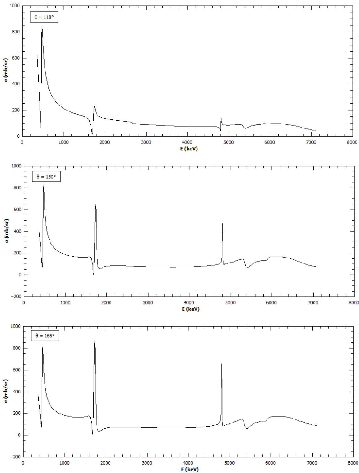
**Slika 2.11.** Vrijednosti diferencijalnog udarnog presjeka za  $^{12}\text{C}(\text{p},\text{p})^{12}\text{C}$  reakciju u ovisnosti o energiji upadnog protona za kutove raspršenja  $118^\circ$ ,  $150^\circ$  i  $165^\circ$ .
