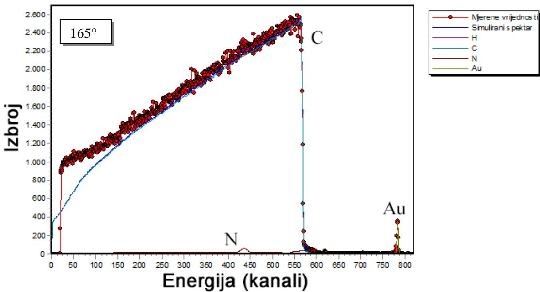
**Slika 6.9.** Primjer spektra kod kojeg je vidljivo dobro slaganje mjerenih i ocijenjenih podataka. Radi se o  $\text{o}-\text{C}(\text{p},\text{p})\text{C}$  reakciji gdje je energija protona  $3.517 \text{ MeV}$ , a kut raspršenja  $165^\circ$ . Odstupanje iznosi  $0.5\%$ .
