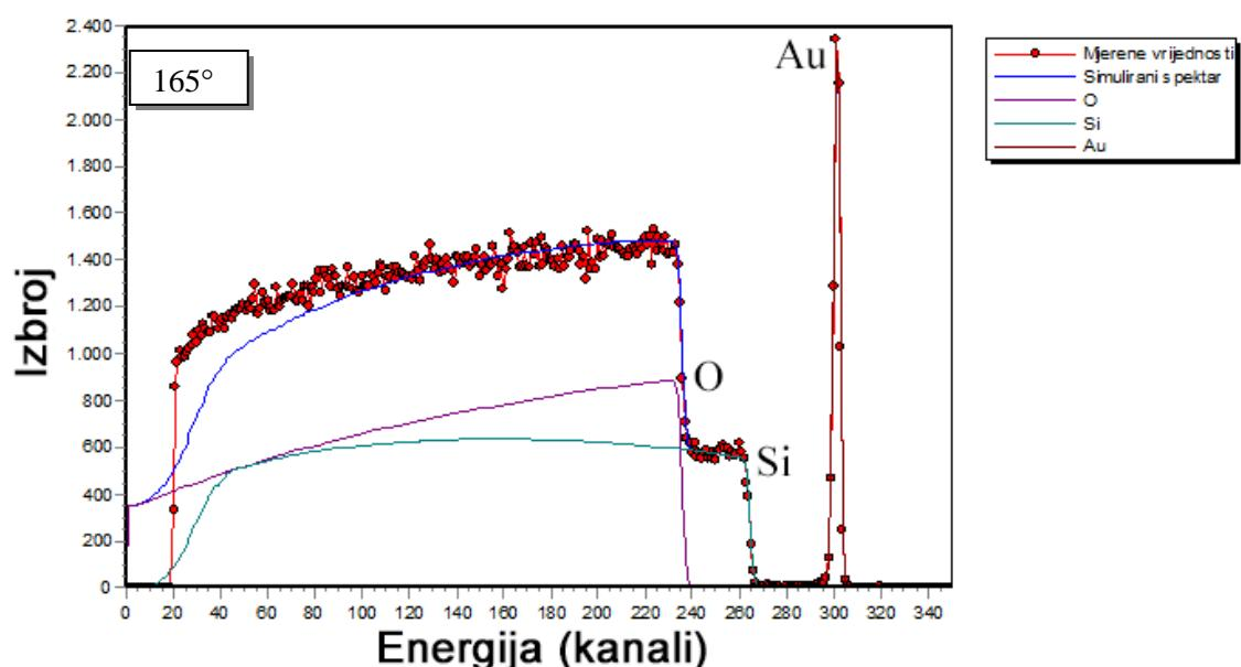
**Slika 6.15.** Primjer spektra kod kojeg je vidljivo dobro slaganje mjerenih i ocijenjenih podataka. Radi se o  ${}^{\text{o}}\text{Si}(\text{p},\text{p}){}^{\text{nat}}\text{Si}$  reakciji gdje je energija protona 1.404 MeV, a kut raspršenja  $165^\circ$ . Odstupanje iznosi 1.3%.
