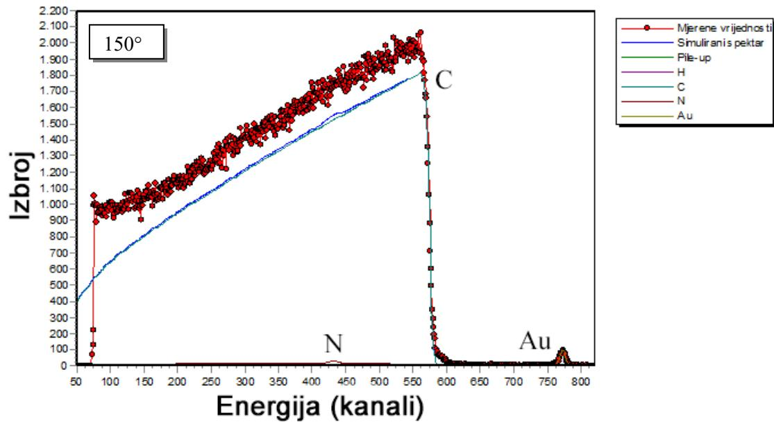
**Slika 6.4.** Simulirani spektar i eksperimentalni spektar raspršenja protona energije 3.5MeV na meti od ugljika za kut raspršenja od  $150^\circ$
