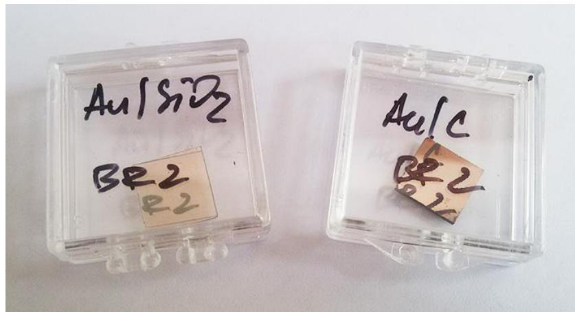
Slika 4.1. Mete  $^{\text{nat}}\text{SiO}_2$  i  $^{12}\text{C}$  s naparenim slojem zlata korištene u eksperimentu.
