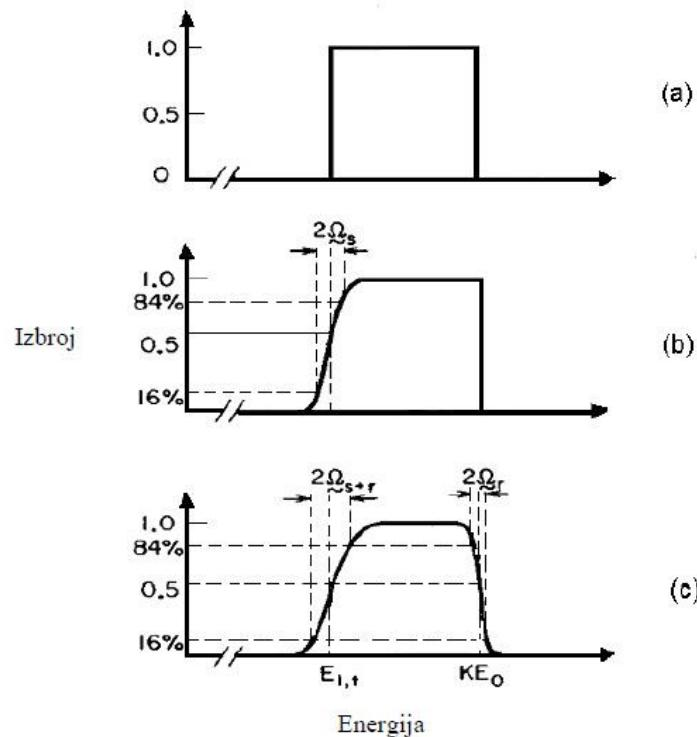
**Slika 2.9.** (a) Izgled idealnog spektra tankog filma. (b) Izgled spektra promijenjen efektom energijskog rasipanja. (c) Izgled spektra promijenjen utjecajem energijskog razlučivanja sustava.
