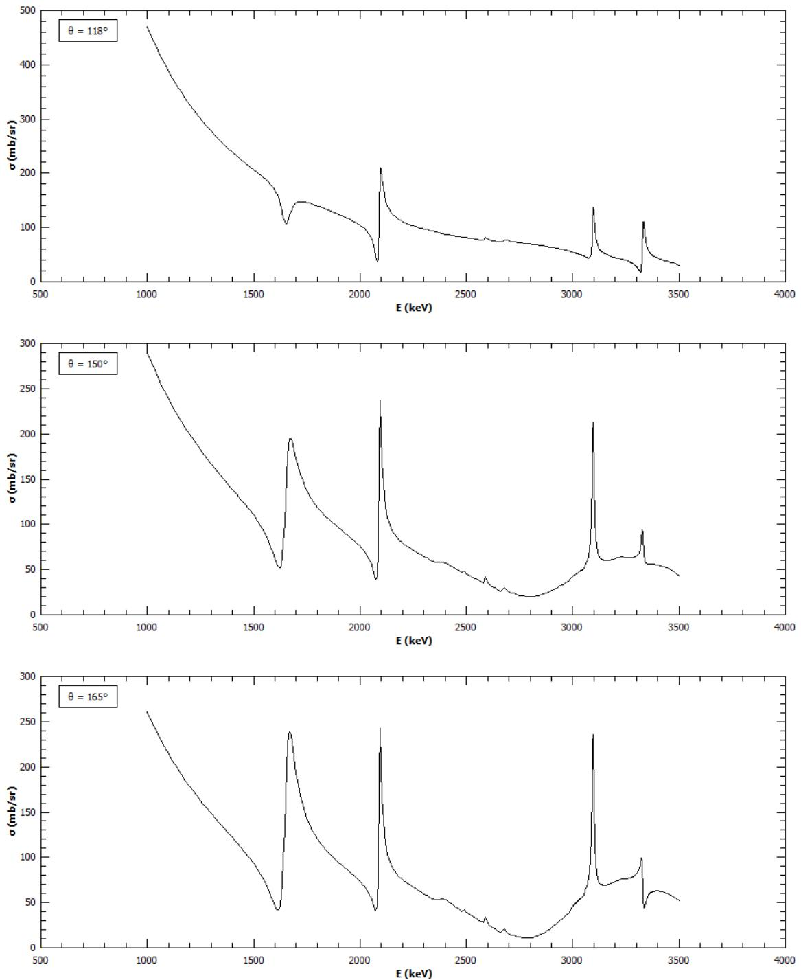
**Slika 2.13.** Vrijednosti diferencijalnog udarnog presjeka za  ${}^{nat}\text{Si}(p,p){}^{nat}\text{Si}$  reakciju u ovisnosti o energiji upadnog protona za kutove raspršenja  $118^\circ$ ,  $150^\circ$  i  $165^\circ$ .
