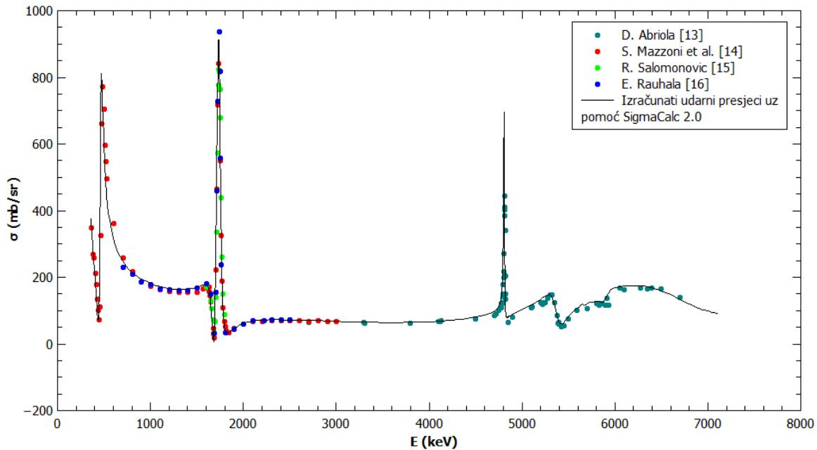
**Slika 2.10.** Diferencijalni udarni presjeci za  $^{12}\text{C}(\text{p},\text{p})^{12}\text{C}$  u ovisnosti o energiji upadnog protona za kut raspršenja od  $170^\circ$ .
