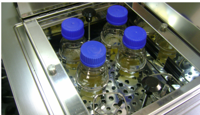
Slika 3. Vodena kupelj s treslicom
