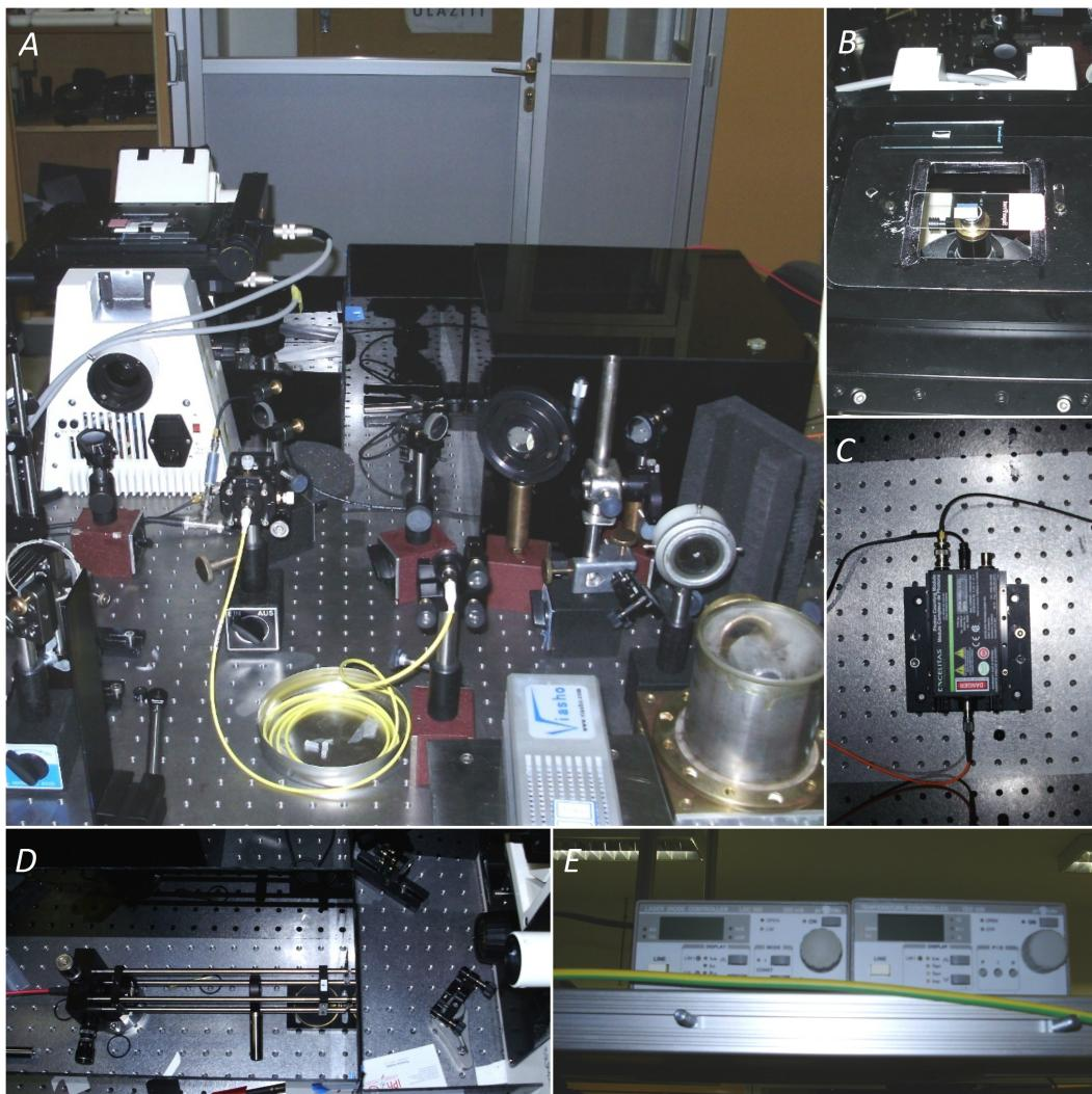
**Slika 3.9:** A) FCS postav sklopljen na Institutu za fiziku. Na slici se vide laser, različita zrcala, optičko vlakno te kućište s objektivom. U crnim kutijama nalaze se iris i detektor. B) Objektiv i kutijice s uzorcima. C) Detektor. D) Izlazni dio postava s filtrom, irisom i optičkim vlaknom. E) Regulatori temperature diode i struje kroz diodu.
