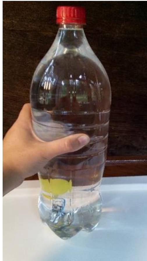
Slika 4.7. Pritiskom boce ronilac tone.
