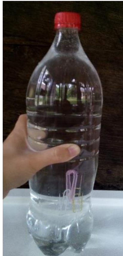
Slika 4.12. Pritiskom boce ronilac tone.
