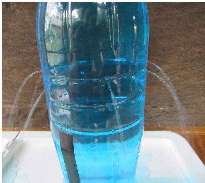
Slika 4.3. Plastična boca s rupicama na istoj visini.
