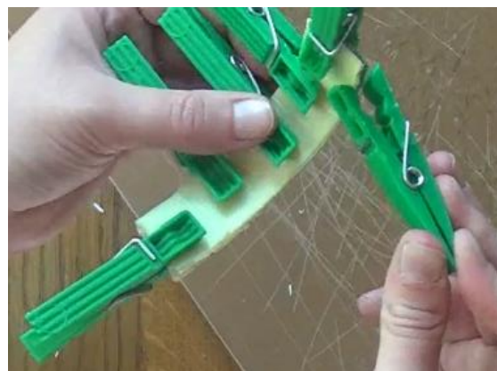
Slika 2.14. Kvačice za rublje pridržavaju zrcala za kolut dok se ljepilo ne osuši.
