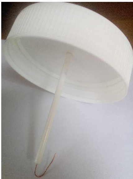
Slika 3.5. Kukica s unutarnje strane poklopca.
