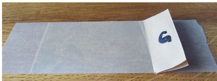
Slika 3.12. Gornja traka zalijepljena na donju traku.
