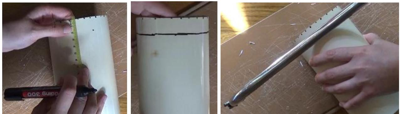
Slika 2.9. Označavanje i piljenje cijevi.
