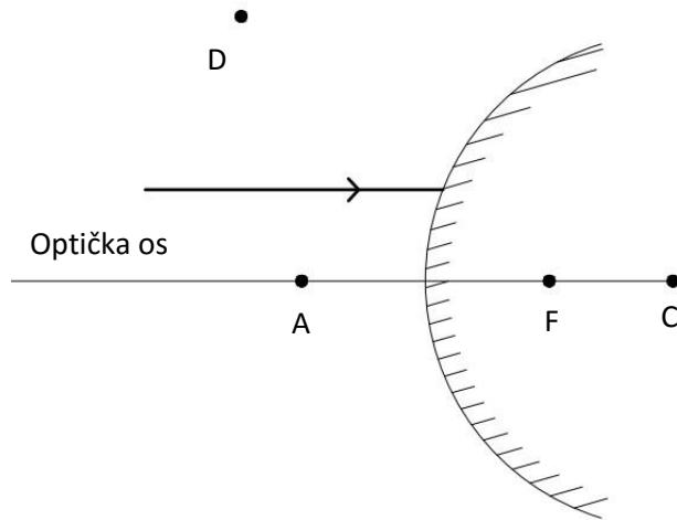
Slika 6.4. Zraka paralelnu optičkoj osi upada na konveksno zrcalo.
