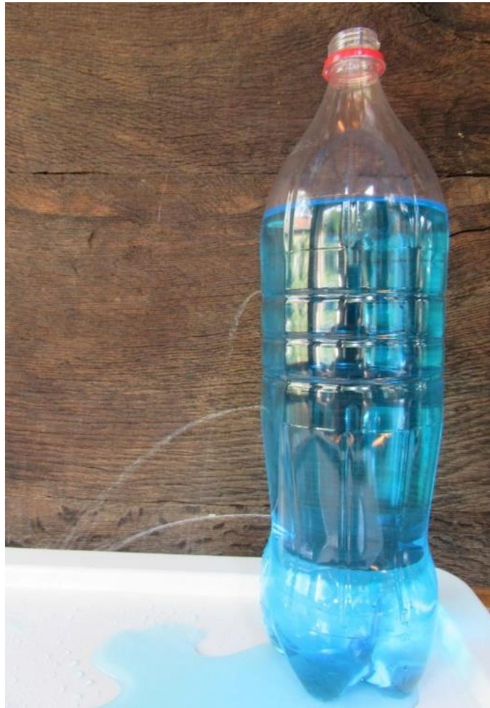
Slika 4.2. Plastična boca s 3 rupice na različitim visinama.
