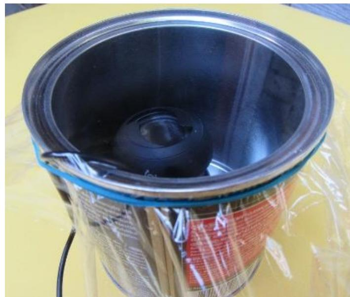
Slika 5.11. Posuda sa zvučnikom prekrivena prozirnom folijom učvršćena kuhinjskom guminicom.
