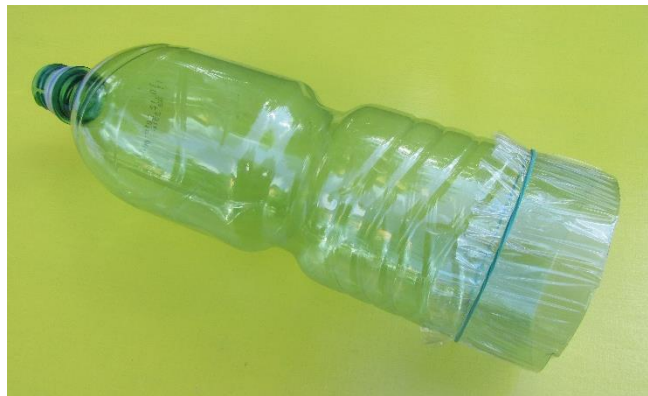
Slika 5.7. Prozirna folija preko otvora boce učvršćena gumicom.
