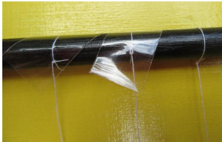
Slika 5.4. Usklađivanje duljine konca ljepljivom trakom.
