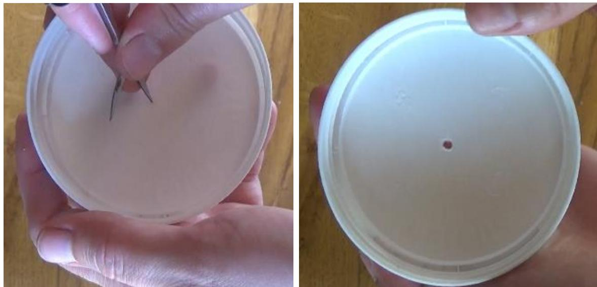
Slika 3.1. Oštrim škaricama izbuši se rupica na sredini plastičnog čepa.
