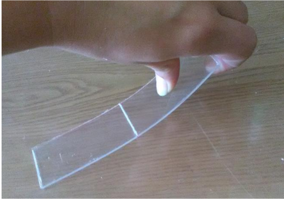
Slika 8. Prikaz elastičnosti pleksiglasa i način odvajanja ploha.
