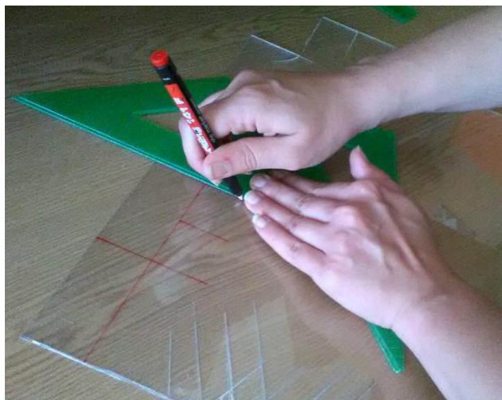
Slika 4. Zacrtavanje geometrijskih likova na pleksiglas.
