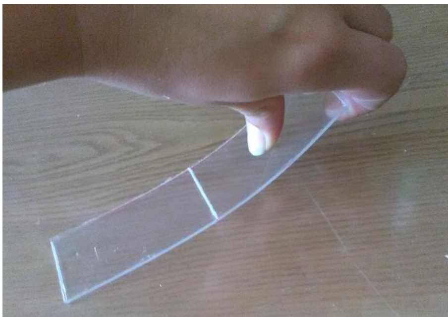
Slika 8. Prikaz elastičnosti pleksiglasa i način odvajanja ploha.
