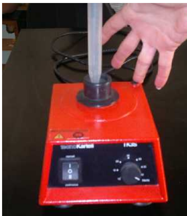
Slika 7. Kartell TK3S homogenizator (odvajanje imobiliziranih bakterijskih stanica)
