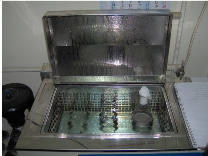
Slika 6. Vodena kupelj s drmalicom za uzgoj kvasca.
