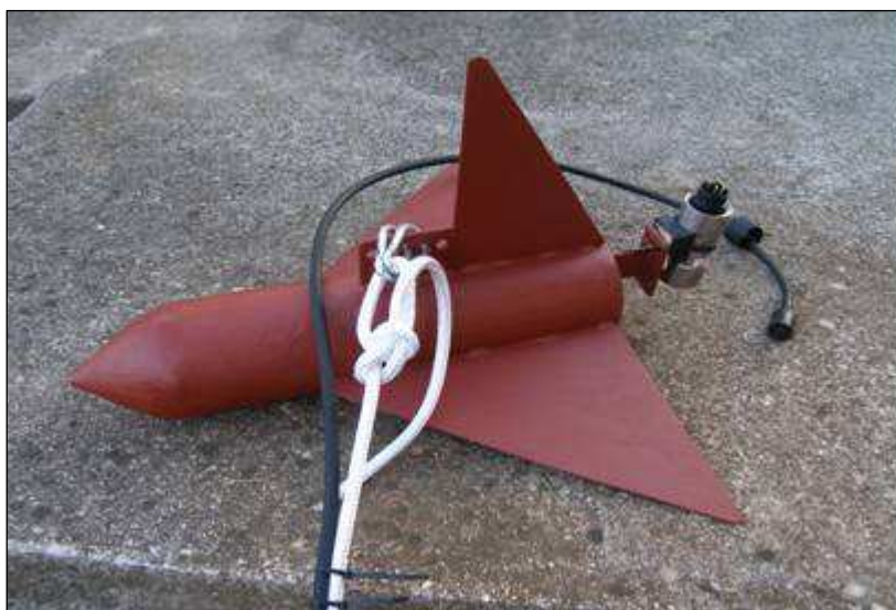
Slika 6. Metalna konstrukcija - „riba“ - na čijem „repu“ je pričvršćena podvodna kamera tako da može snimati dno pod pravim kutom (snimila T. Bakran-Petricioli)
