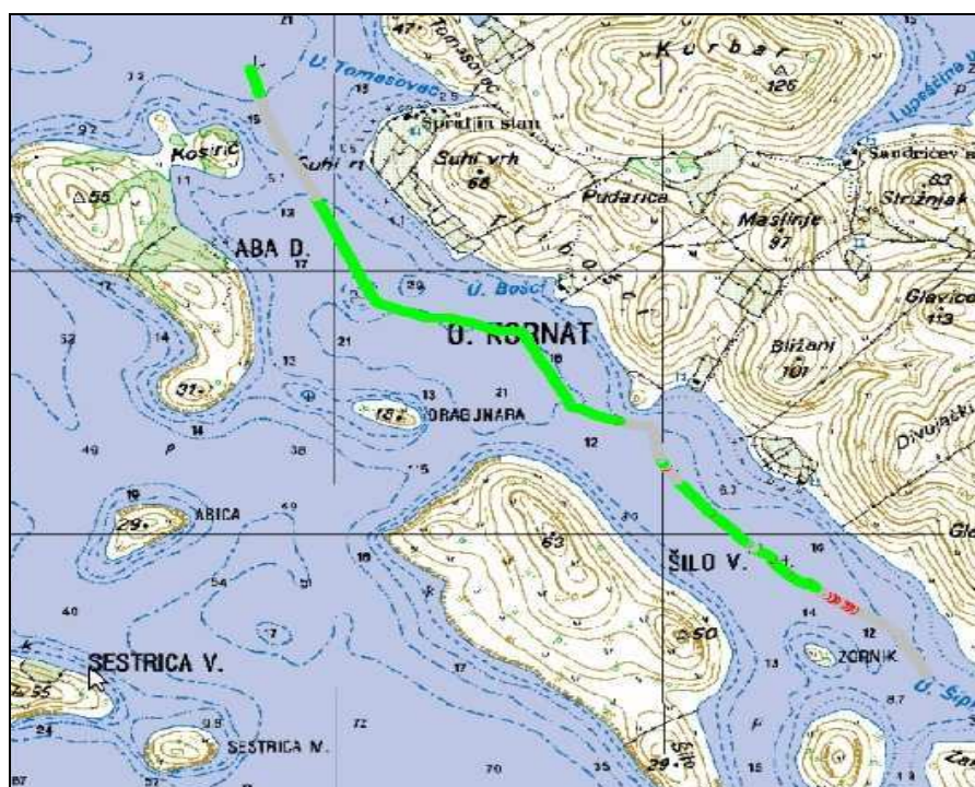
Slika 11. Transekt korn 1 snimljen je 26. travnja 2009. godine geo-referenciranom podmorskom video-metodom u NP Kornati te je preklopljen s nautičkom kartom. Dijelovi transekta na kojima je uočena posidonija označeni su zelenom bojom, a tamo gdje su uočene periske označeno je crvenom bojom.
