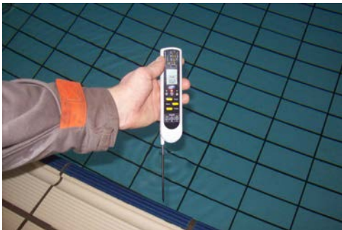
Slika 16. Mjerenje temperature vode u bazenu (Digital termometer) (Vlastita fotografija)
