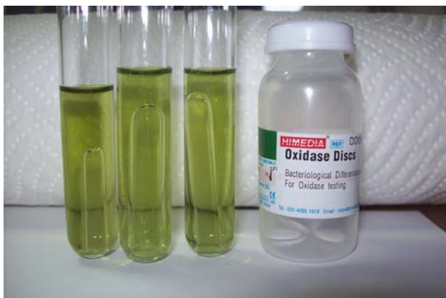
Slika 10. Brilliant green potvrđni test za koliformne bakterije (Vlastita fotografija)
