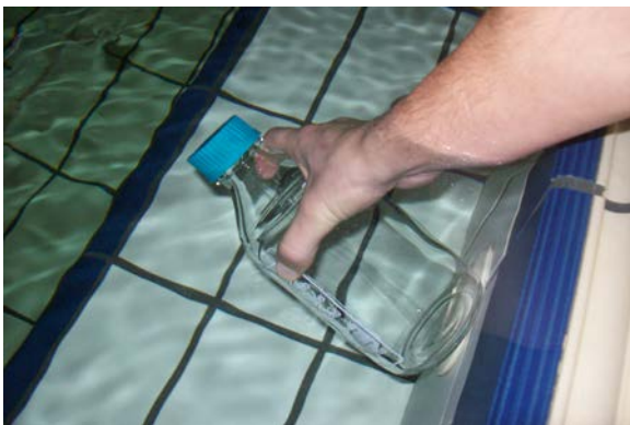
Slika 5. Uzimanje uzorka sterilnom bocom zapremnine 500 mL (Vlastita fotografija)
