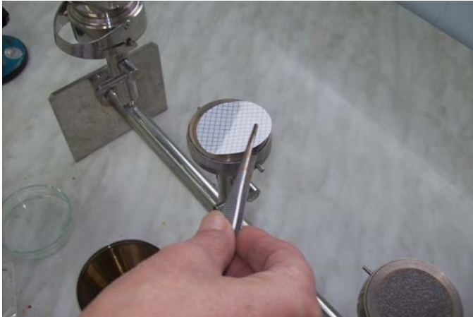
Slika 8. Stavljanje filtra na podložak za filter na uređaju za membransku filtraciju (Vlastita fotografija)
