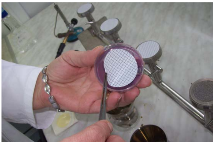
Slika 12. Stavljanje filtra na m-FCA agar (Vlastita fotografija)
