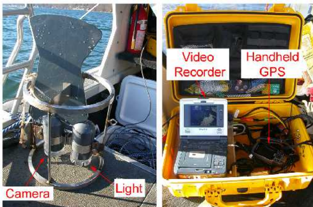
Slika 12. Osnovne komponente podvodnog video sustava za kartiranje koji se povla i kroz vodu (Stevens i sur., 2008).
