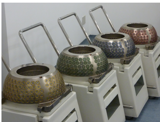
(a) Kolimatorske kacige s kolimatorima promjera 4, 8, 14 i 18 mm.
