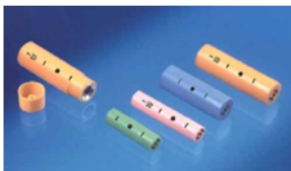
(a) Plastični držači u koje se stavljaju stakleni štapićasti detektori.
