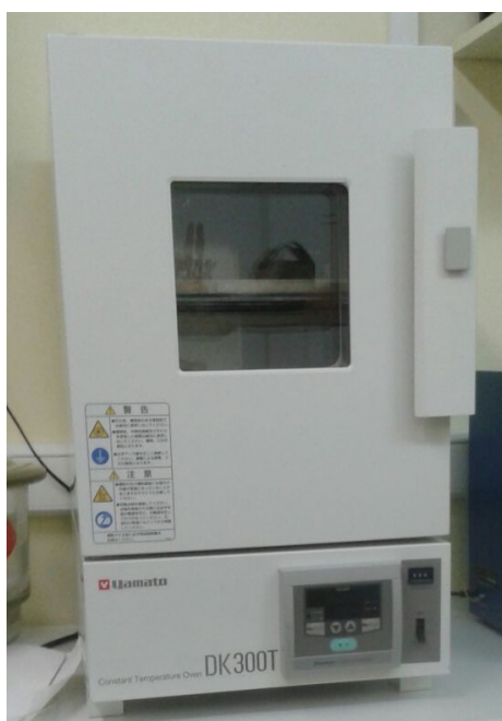
(a) Peć za predgrijavanje Yamato DK300T.
