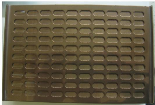
(b) Metalni držač za detektore.
