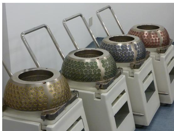
(a) Kolimatorske kacige s kolimatom promjera 4, 8, 14 i 18 mm.
