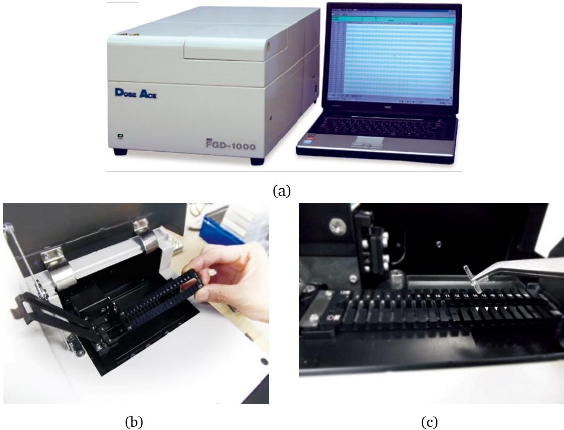
Slika 3.2: Čitač Dose Ace FGD-1000 (a), postupak stavljanja stalka u čitač (b) i detektora u stalak (c) [22].
