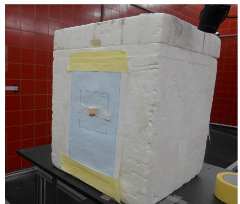
(b) Dozimetri za provjeru kalibracije naljepljeni na stiropor.
