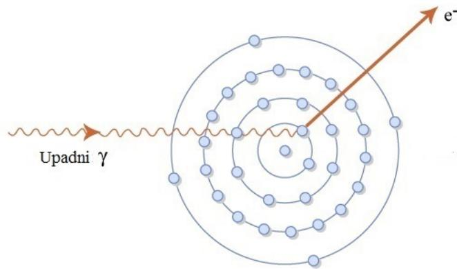
Slika 2.10: Fotoelektrični učinak.
