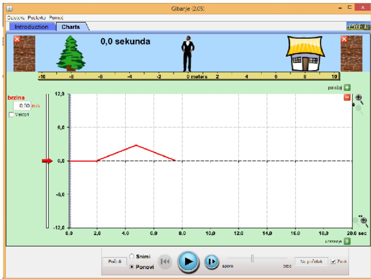
Simulacija je na početku, ostavite nule u sve tri ćelije te pokrenete simulator otprilike dvije sekunde, zaustavite. Nakon toga upišete ubrzanje od  $1 \text{ m/s}^2$ , zaustavite ga na 4 m. Stavite ubrzanje  $-1 \text{ m/s}^2$ , pustite da se tako giba do 8 m (dok se ne počne okretati). Odaberite „Ponovi“ umjesto „Snimi“ te sakrijte  $x-t$  i  $a-t$  graf.
