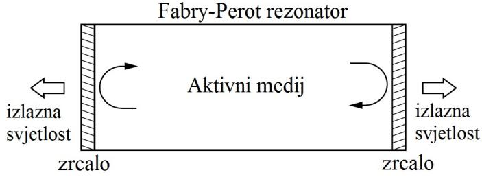
Slika 3.8: Shematski prikaz Fabry-Perot optičkog rezonatora [14].
