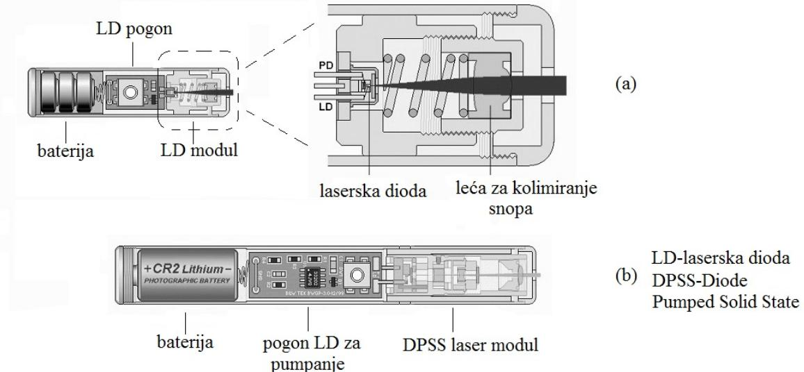
Slika 5.9: Shematski prikaz laserskih pokazivača ostvarenih: (a) diodnim laserom (b) optički pumpanim laserom s čvrstom jezgrom [30].
