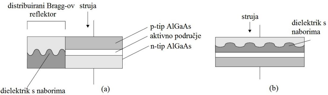
Slika 5.5: Laserska dioda s: (a) distribuiranim Bragg-ovim reflektorm, (b) distribuiranom povratnom vezom [12].
