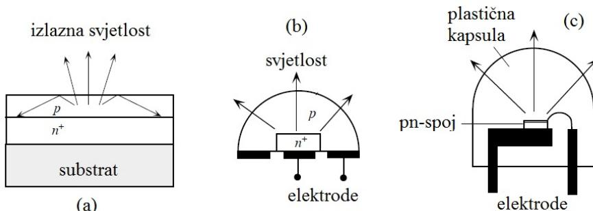
Slika 3.6: (a) Zbog totalne refleksije dio svjetlosti ne može napustiti materijal. Dvije metode koje se koriste za smanjenje gubitaka: (b) p-tip materijala je načinjen kao kupola, (c) pn-spoj je okružen plastičnom kapsulom koja ima veći indeks loma od zraka [13].
