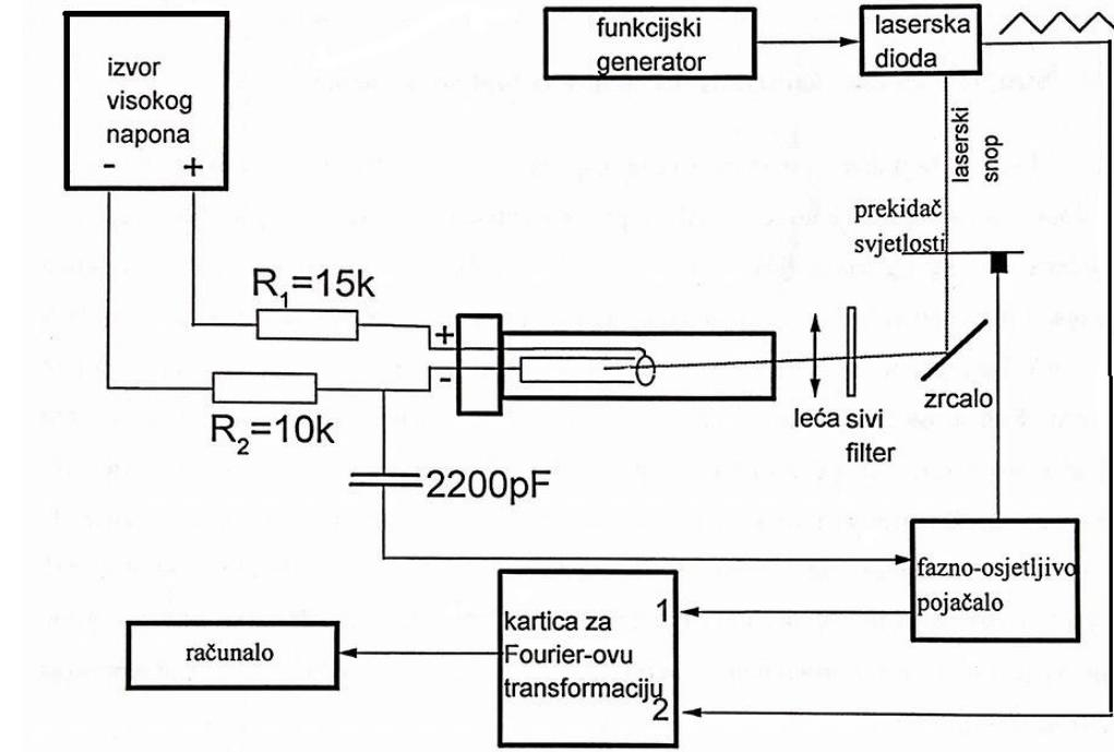
Slika 5.10: Shema uređaja za ispitivanje izboja optogalvanskom detekcijom [31].
