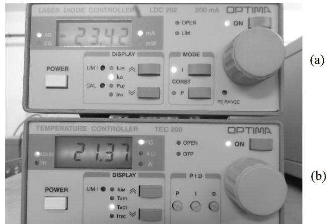
Slika 4.6: Uređaj za kontrolu: (a) struje kroz lasersku diodu, (b) temperature laserske diode.
