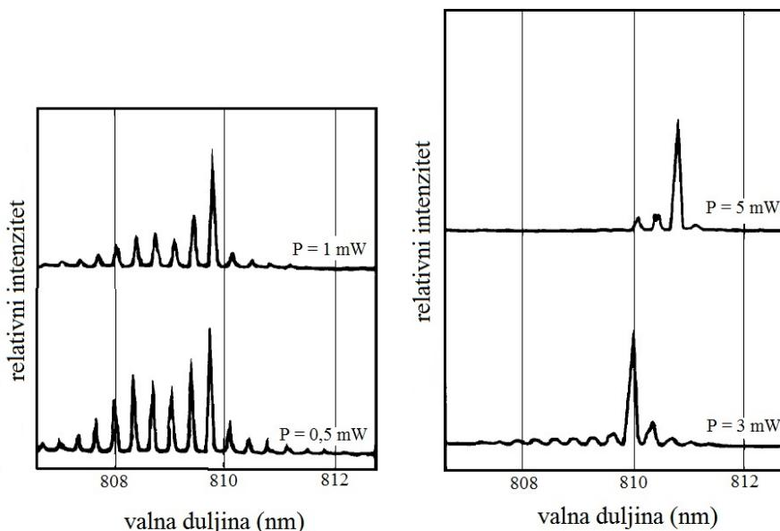
Slika 4.8: Graf ovisnosti relativnog intenziteta poluvodičkog diodnog lasera o valnoj duljini za različitu izlaznu optičku snagu [16].
