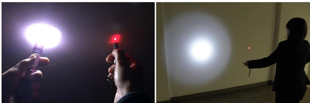
**Slika 4.6.3 Usmjerenost laserskog snopa**
