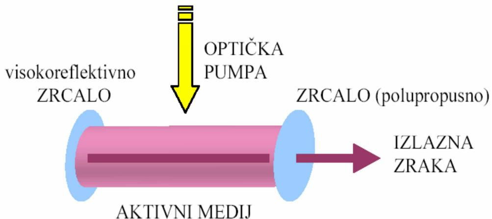
**Slika 2.5 Shematski prikaz osnovnih dijelova lasera [20]**
