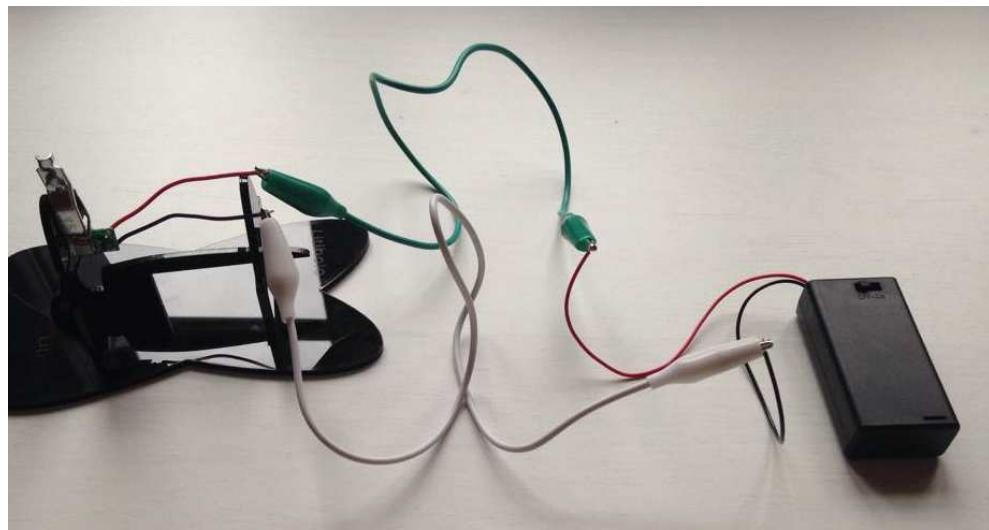
Slika 4.5.6 Utor za baterije spojen s laserskom diodom
