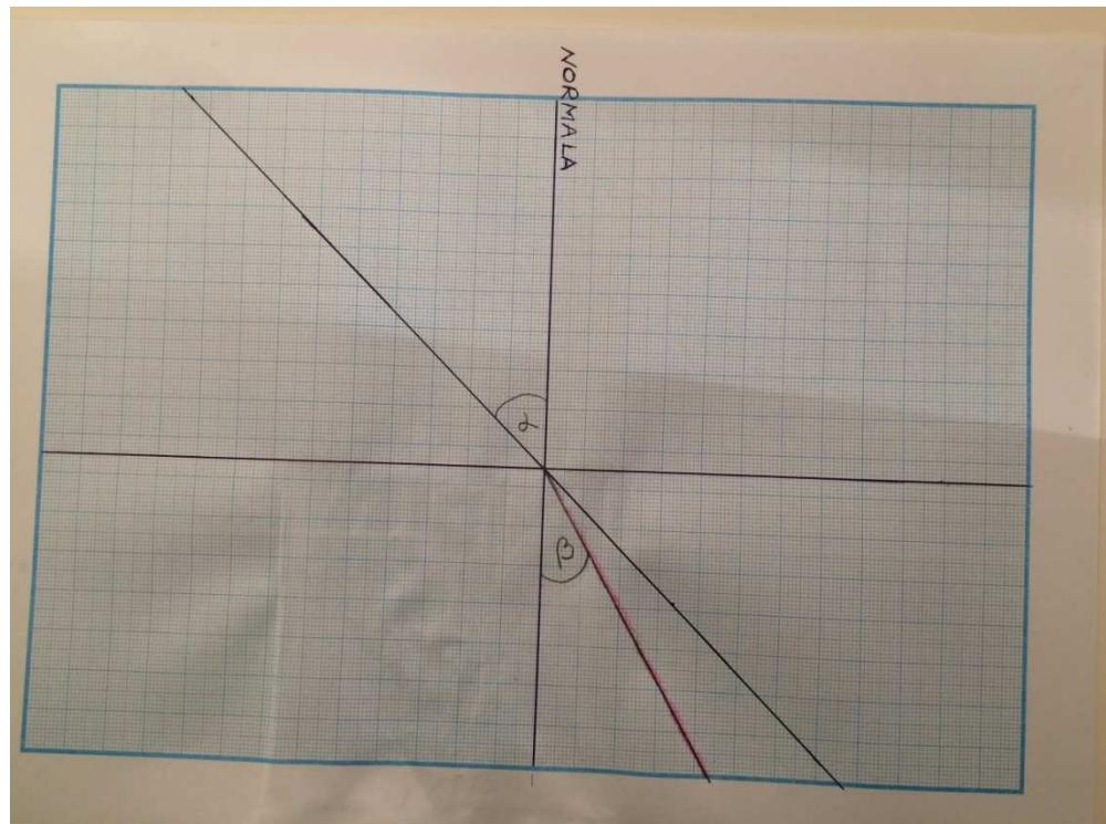
Slika 4.3.5 Izmjereni kut izlazne zrake crvene svjetlosti
