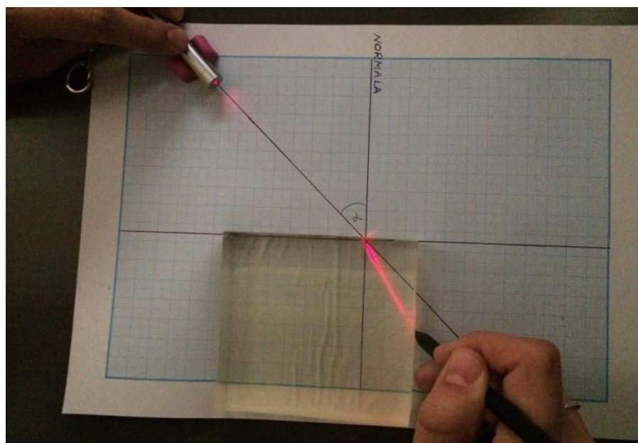
Slika 4.3.3 Mjerenje kuta izlazne zrake crvene svjetlosti
