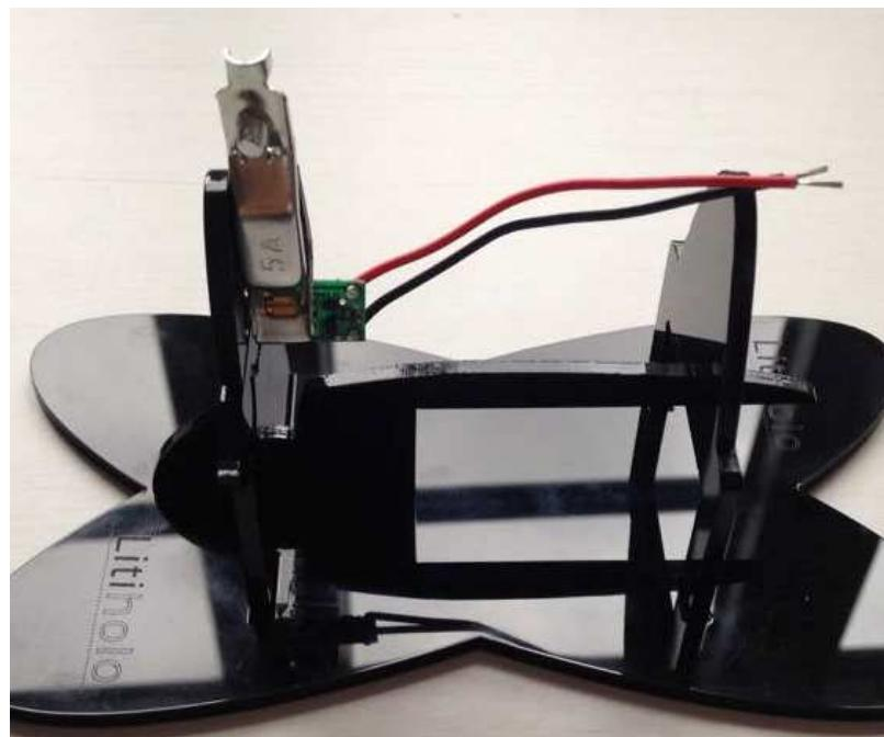
Slika 4.5.7 Dio eksperimentalnog postava s štipaljkom, laserskom diodom i kružnom pločom
