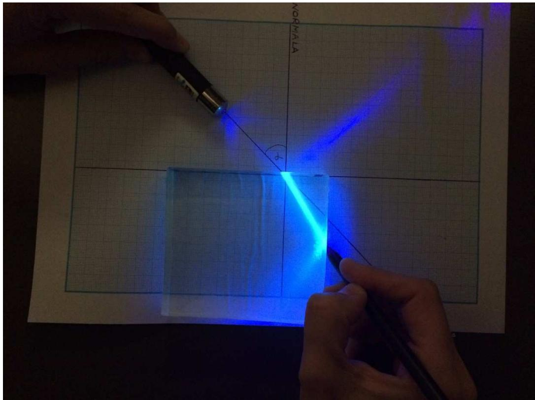
Slika 4.3.6 Mjerenje kuta izlazne zrake plave svjetlosti
