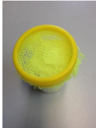
Slika 13. Primjer pripremljene posudice s razvučenom mrežicom pričvršćenom čepom
