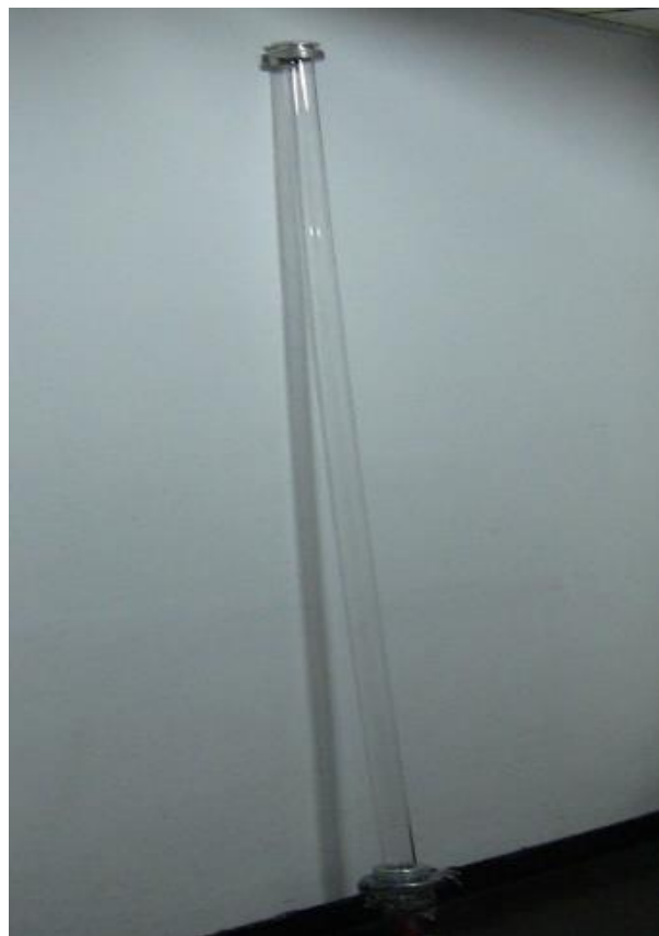
Slika 4.8.1. Newtonova cijev duljine dva metra, vanjskog promjera četiri centimetara izrađena od pleksiglasa
