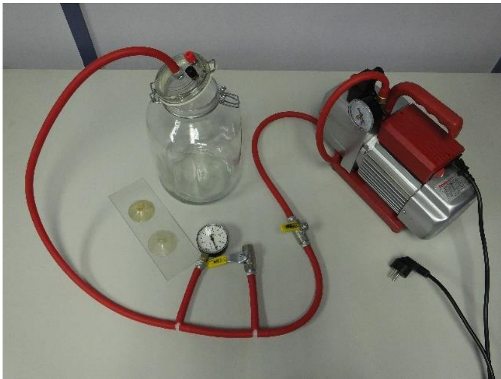
Slika 4.7.1. Eksperimentalni postav za vježbu vakuumske hvataljke
