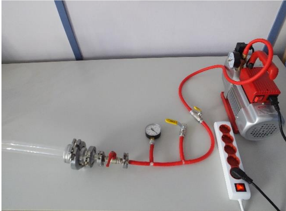
Slika 4.8.2. Eksperimentalni postav za vježbu slobodni pad
