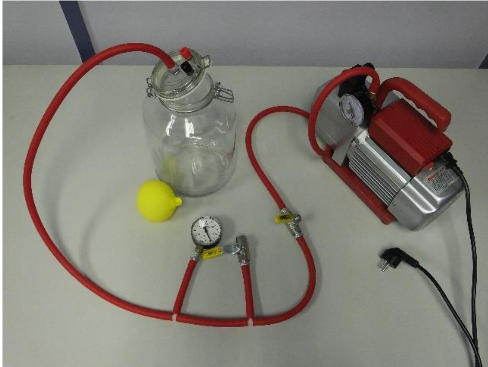
Slika 4.1.1. Eksperimentalni postav za vježbu balon u vakuumu
