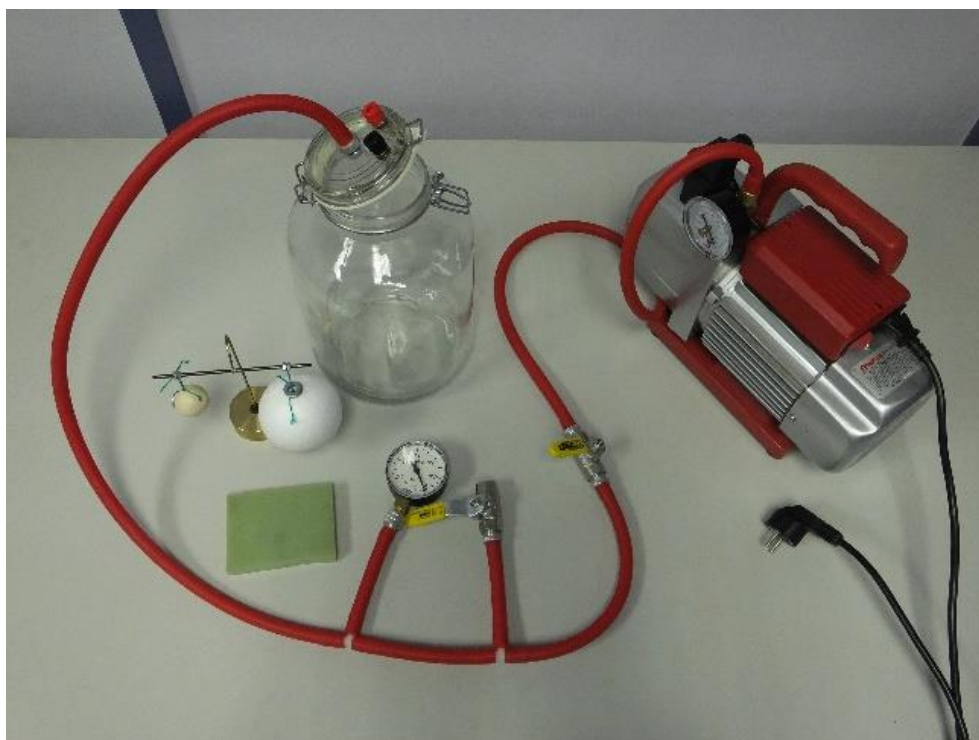
Slika 4.5.1. Eksperimentalni postav za vježbu uzgon u zraku
