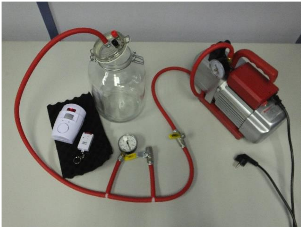
Slika 4.4.1. Eksperimentalni postav za vježbu zvuk u vakuumu
