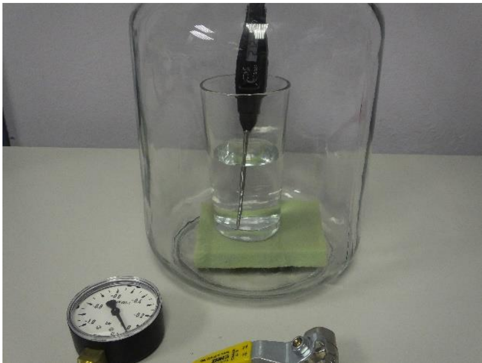
Slika 4.3.3. Čaša s destiliranom vodom i termometrom na spužvici u staklenci
