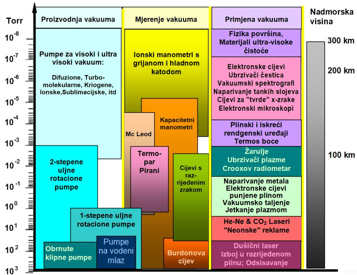
Slika 2.2.1. Različite vakuumske sisaljke, mjerni instrumenti te neke primjene vakuuma
