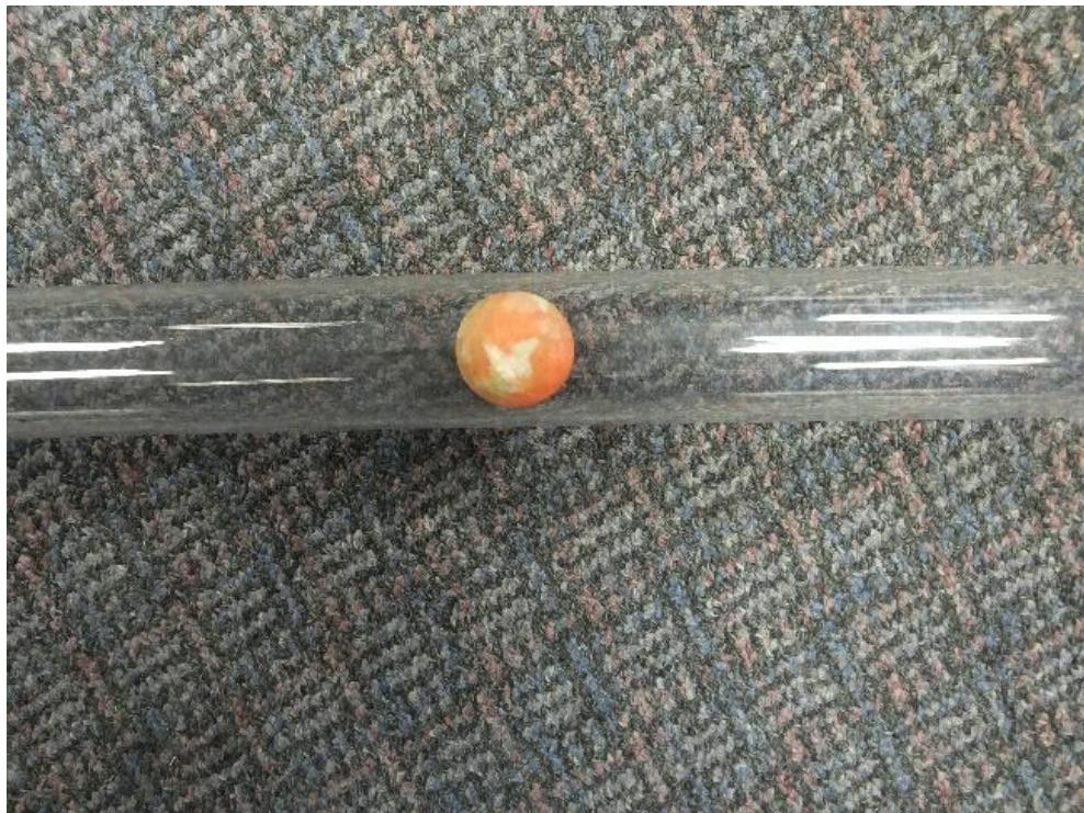
Slika 4.8.4. Gumena kuglica u Newtonovoj cijevi
