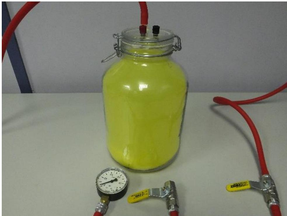
Slika 4.1.3. Balon u staklenici nakon vakuumiranja
