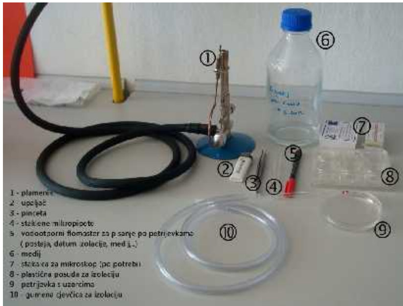
Slika 4. Osnovni laboratorijski pribor za izolaciju stanica
