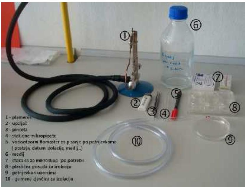
**Slika 4.** Osnovni laboratorijski pribor za izolaciju stanica
