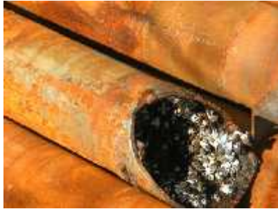
Slika 5. Obraštaj u cijevi ( www.learnnc.org )
