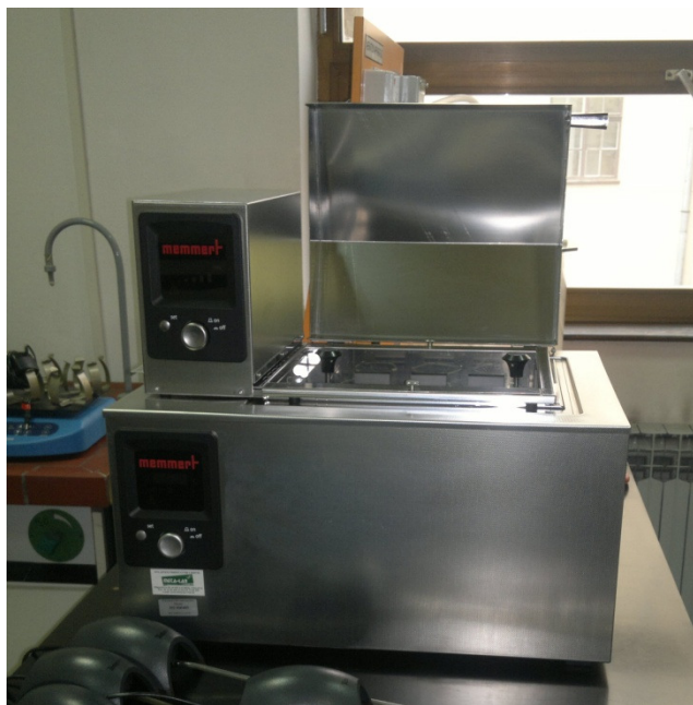
Slika 5. Memmert WNB vodena kupelj s mješalicom
