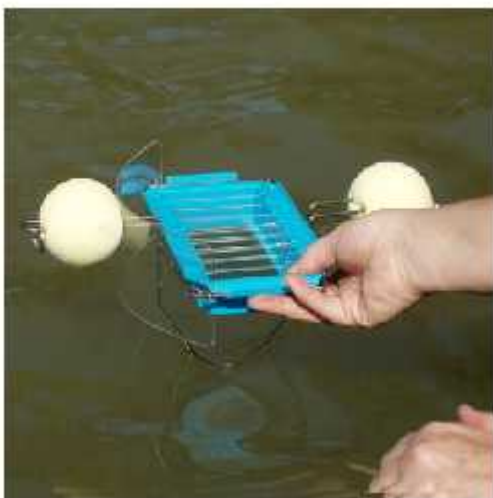
Slika 9. Plutaju i umjetni substrat sa staklenim predmetnicama
