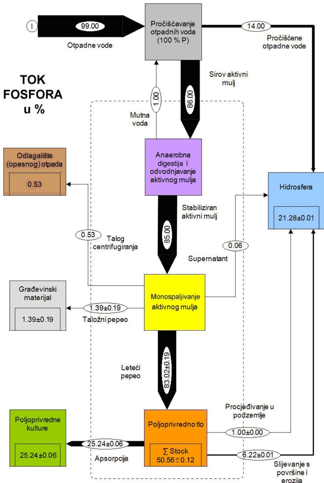
Slika 17: Analiza toka fosfora iz otpadnih voda kao dijela aktivnog mulja korištenog nakon monospaljivanja u poljoprivredi prikazana u postocima u STAN-softveru.
