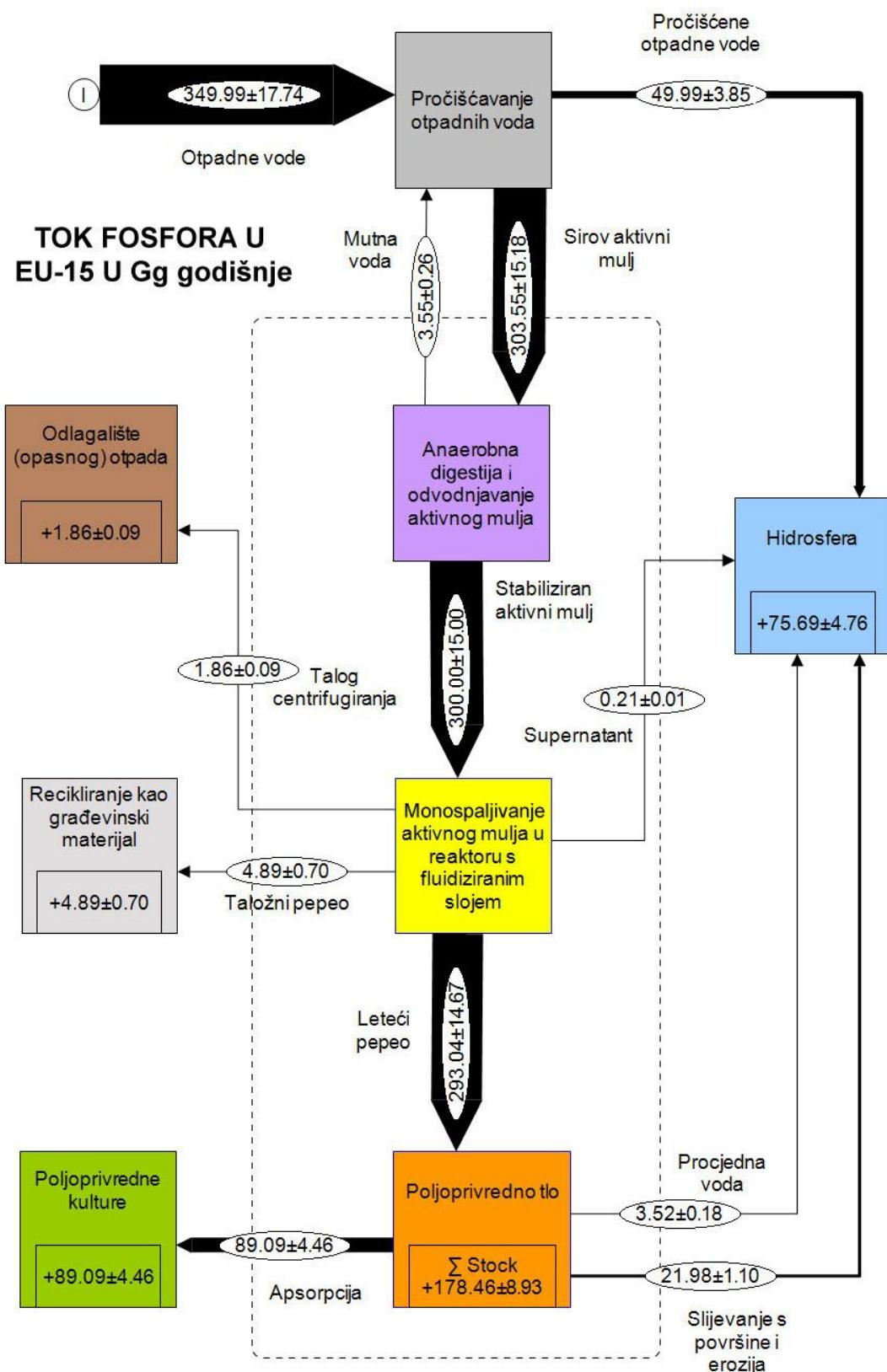
Slika 18: Analiza toka fosfora iz otpadnih voda EU-15 kao dijela aktivnog mulja korištenog nakon monospaljivanja u poljoprivredi prikazana u Gg godišnje u STAN-softveru.
