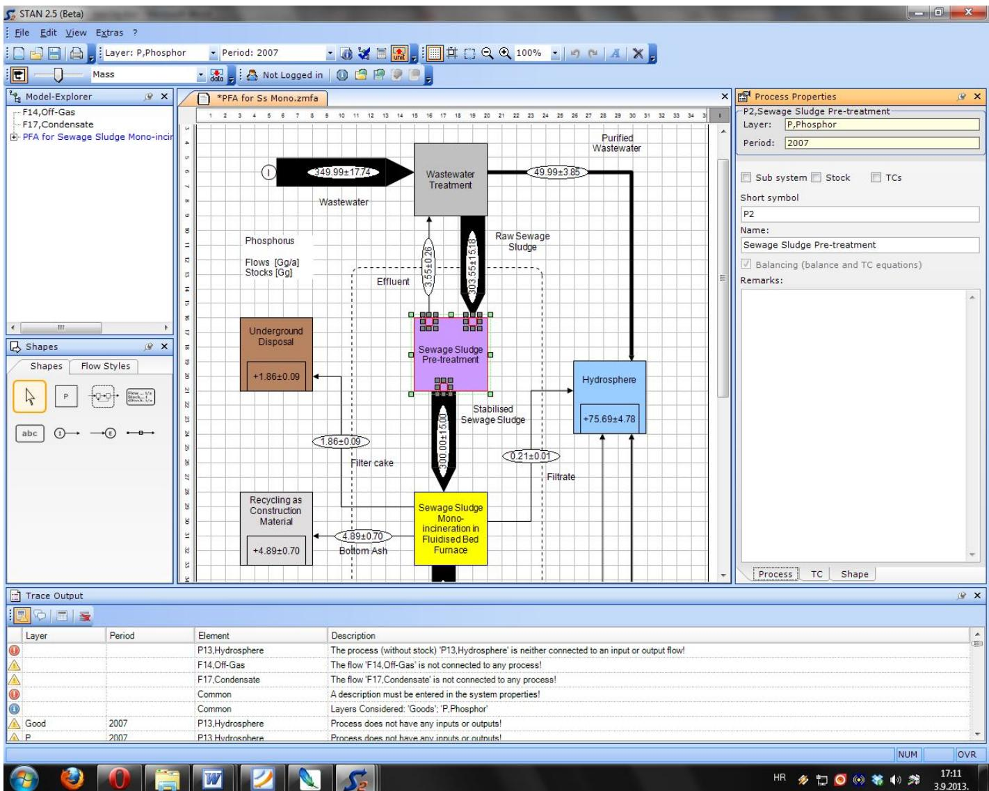
**Slika 9:** Grafičko sučelje STAN-softvera nakon izračuna toka fosfora u sustavu koji prati fosfor u procesu spaljivanja aktivnog mulja.
