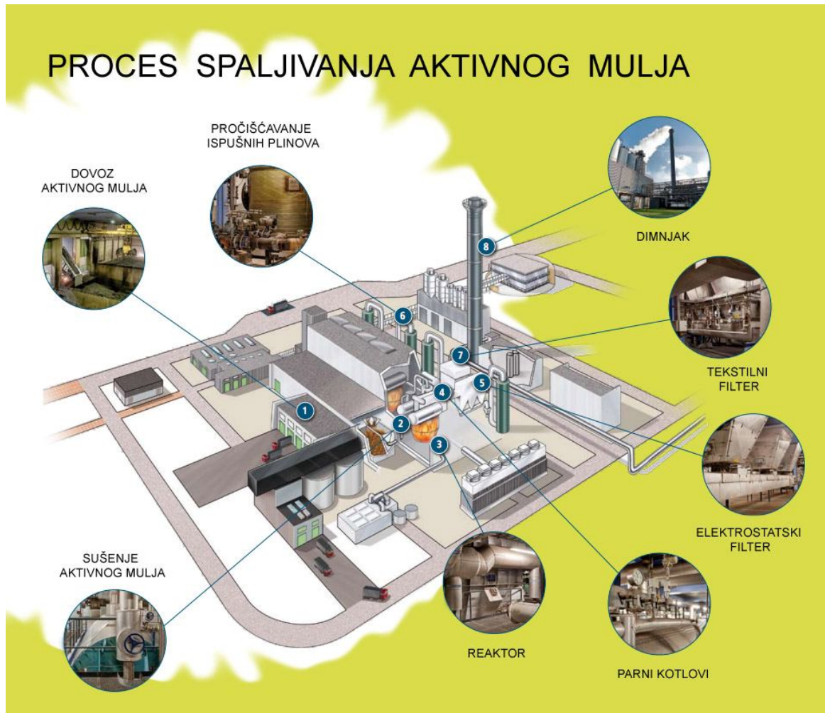
Slika 12: Postrojenje za monospaljivanje aktivnog mulja SNB (SNB, 24.07.2013.).
