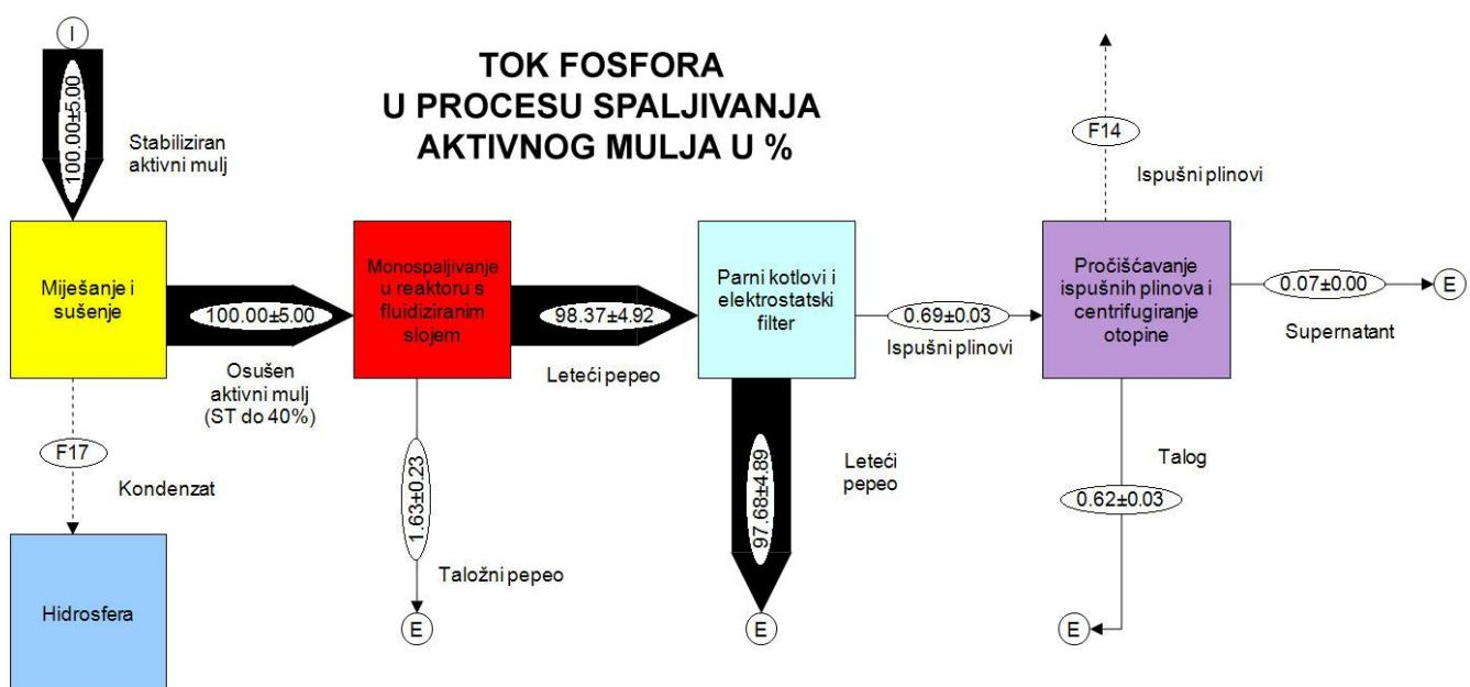
**Slika 16:** Analiza tok fosfora u procesu monospaljivanja aktivnog mulja izražena u postocima, izrađena u STAN-softveru.
