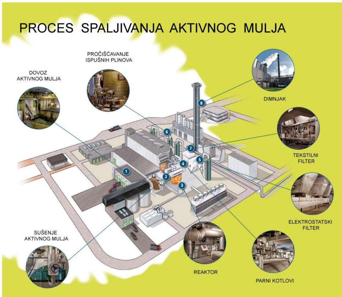
Slika 12: Postrojenje za monospaljivanje aktivnog mulja SNB (SNB, 24.07.2013.).
