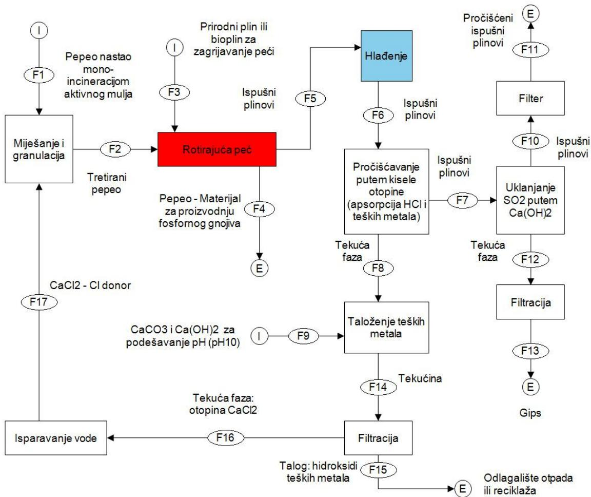
Slika 13: Shema elemenata SUSAN-tehnologije s naglaskom na pročišćavanje ispušnih plinova izrađena u STAN-softveru na temelju skice g. Adama iz BAM-a.
