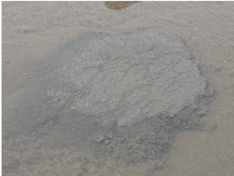
Slika 10 : Aktivni mulj na površini otpadne vode u PPOV (Fotografirala Jelena Radošević na prostoru Centralnog uređaja za pročišćavanje otpadnih voda grada Zagreba 6. svibnja 2009.).
