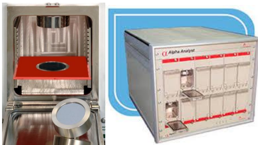
Slika 2.7. Fotografija jedne komore alfa-spektrometra s PIPS-detektorom (lijevo) te jedne jedinice sa setom od 12 komora (desno) (Alpha Analyst™, Canberra)
