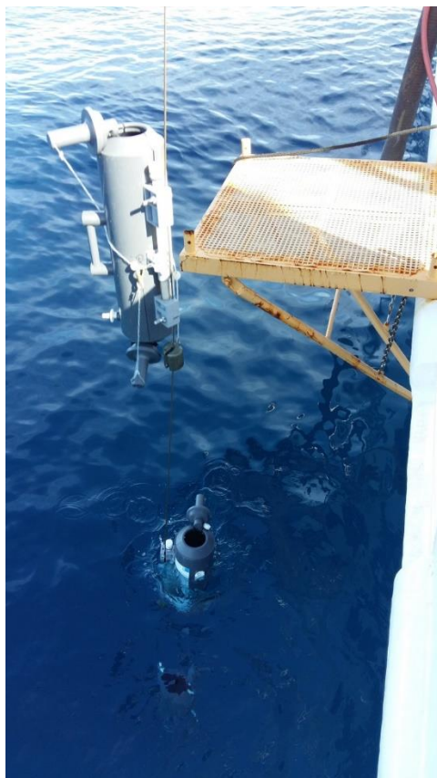
Slika 7. Spuštanje Niskin crpaca u more
