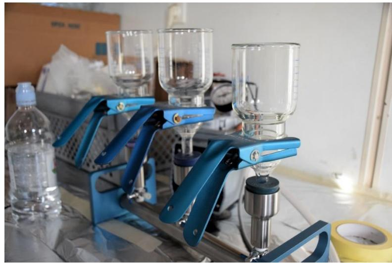
Slika 8. Aparatura za filtraciju
