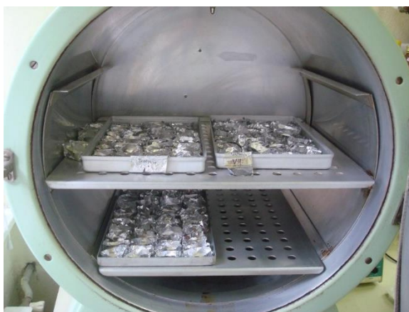
Slika 12. Termostat s lađicama u kojima se na 80 °C suše izolirani organi juvenilnih rakova.
