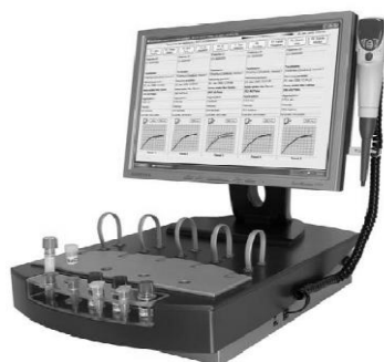
Slika 6. Multiplate analyser uređaj za mjerenje impedancijske agregometrije (ustupljeno ljubaznošću tvrtke Dynabyte Medical, Njemačka).
