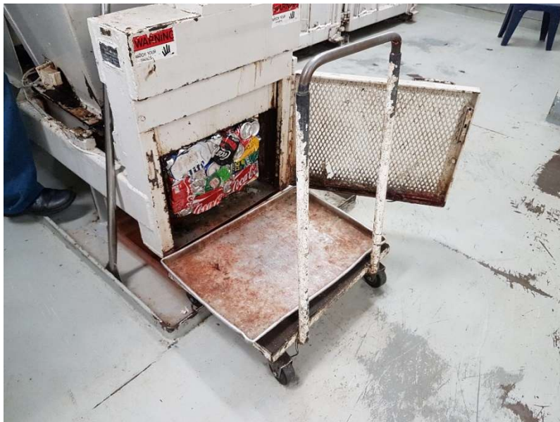
Slika 4.15. Uređaj za prešanje limenki; fotografija: Nikola Marvučić
