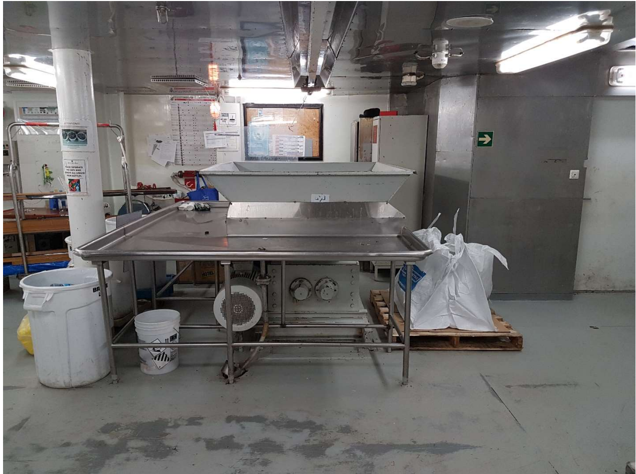
Slika 4.1. Drobilica za usitnjavanje otpada; fotografija: Nikola Marvučić
