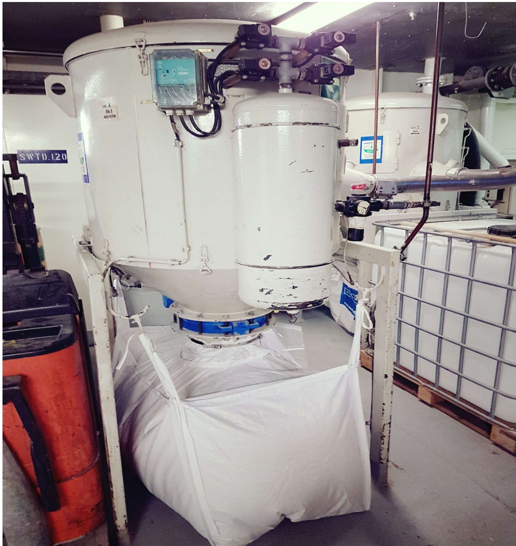
Slika 4.7. Uređaj za sakupljanje pepela; fotografija: Nikola Marvučić
