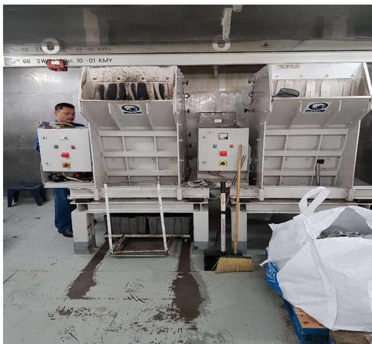
Slika 4.14. Uređaji za drobljenje stakla; fotografija: Nikola Marvučić
