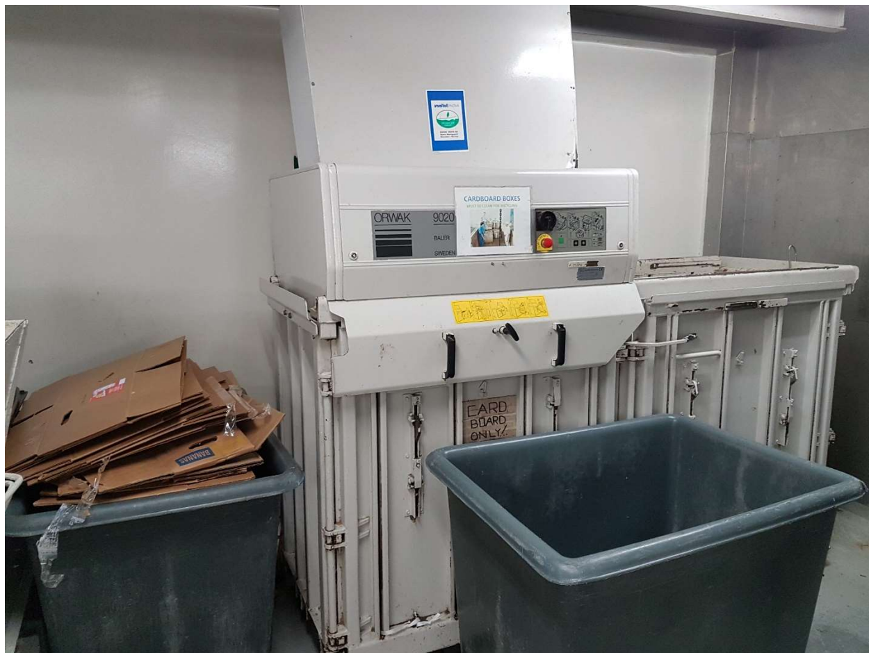
Slika 4.17. Uređaj za prešanje kartona; fotografija: Nikola Marvučić
