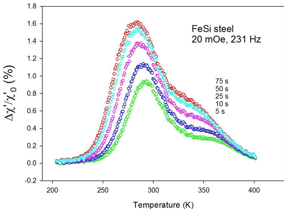
Slika 22. Ishodišna mjerena (gornji panel) za konstrukciju MAE rezultata (donji panel) na uzorku transformatorskog lima (Fe4%Si) u širokom rasponu temperatura ( $100 \text{ K} < T < 400 \text{ K}$ ). Svaka krivulja na gornjem panelu prikazuje relaksaciju AC susceptibilnosti na konstantnoj temperaturi
