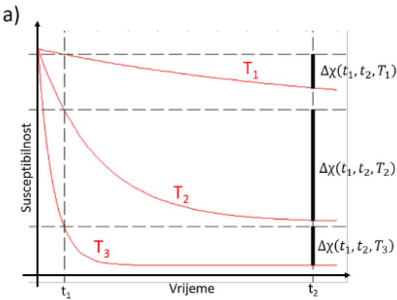
Slika 19. Izotermalna krivulja ovisnosti magnetske susceptibilnosti o vremenu
