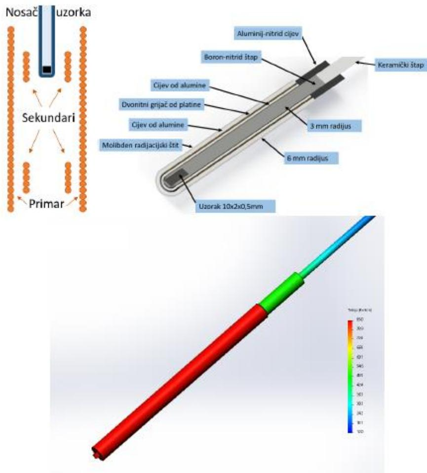
Slika 21. Konstrukcije nosača uzorka za visoko-temperaturna mjerena AC susceptibilnosti i MAE. Na donjoj slici prikazana je modelna raspodjela temperatura (napravljeno u SolidWorksu, autor mr.sc. Vinko Šurija) za zadanu snagu grijaca uzorka (oko 10 W)
