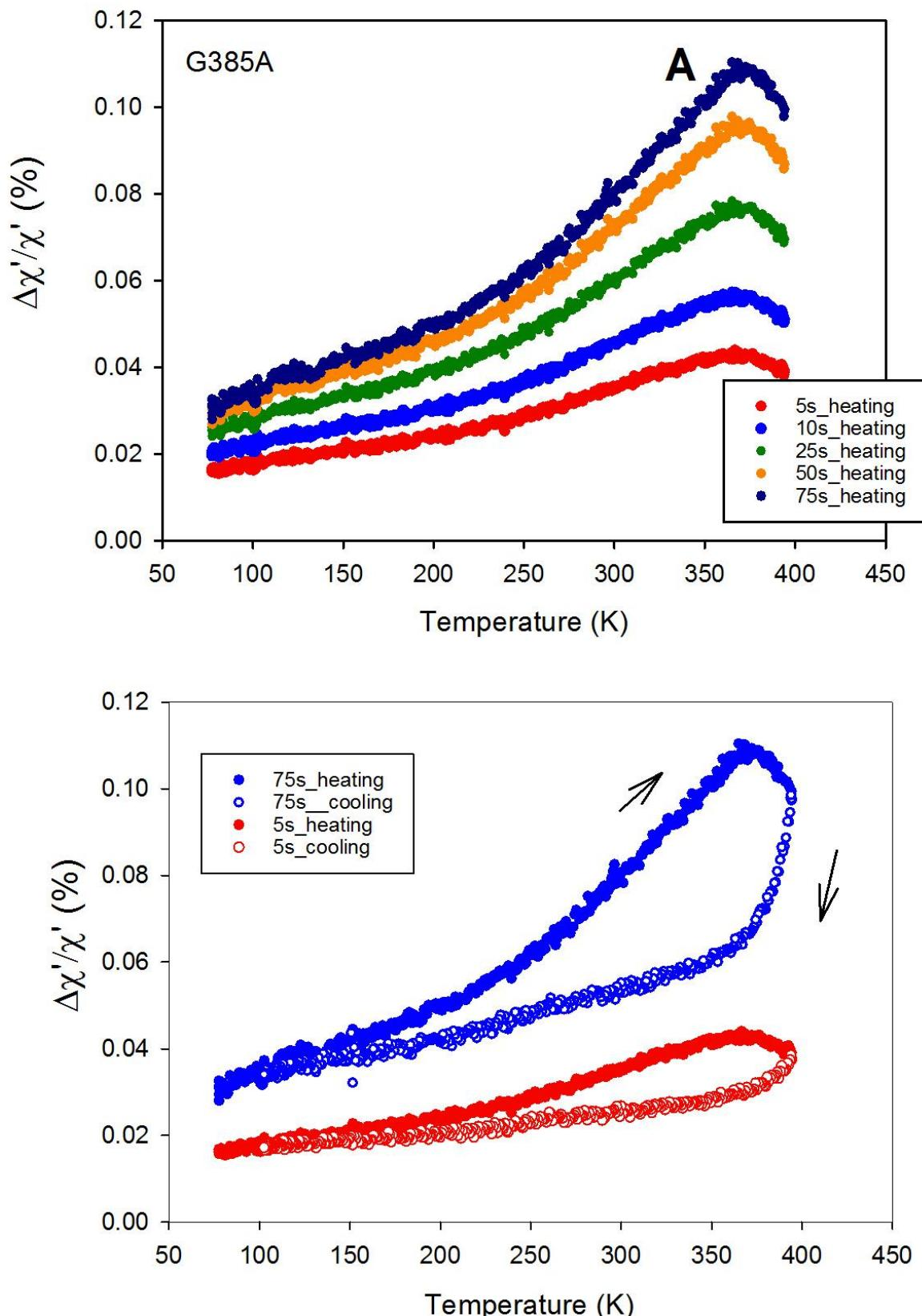
Slika 30 . MAE mjerena za uzorak G385A
