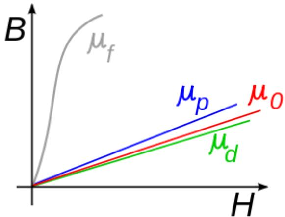
Slika 3. Ovisnost magnetske indukcije o magnetskom polju
