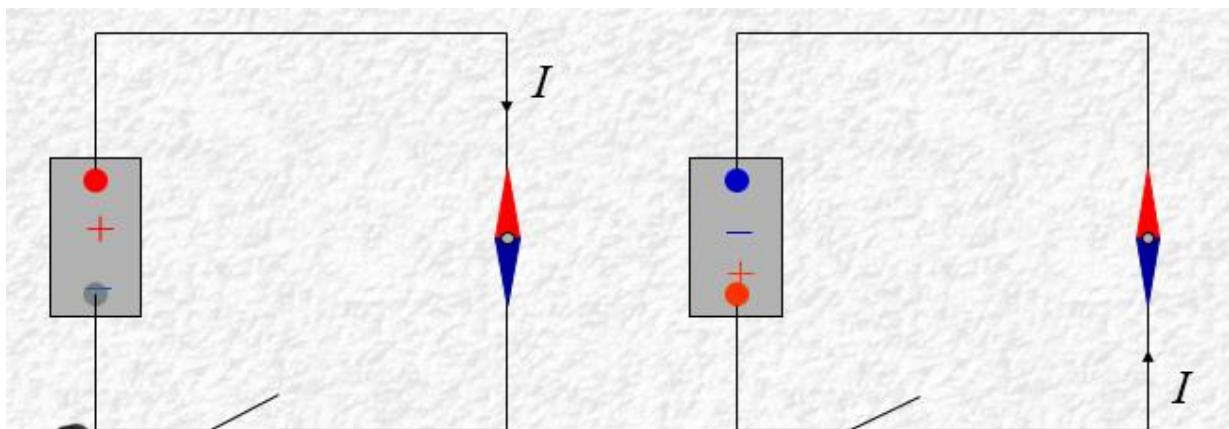
Učenici opažaju da se magnetska igla otklanja u blizini vodiča kojim teče struja. Kada pustimo struju u jednom smjeru magnetska igla se otklanja u jednu stranu,a kada pustimo struju u drugom smjeru magnetska igla se otklanja u drugu stranu.
