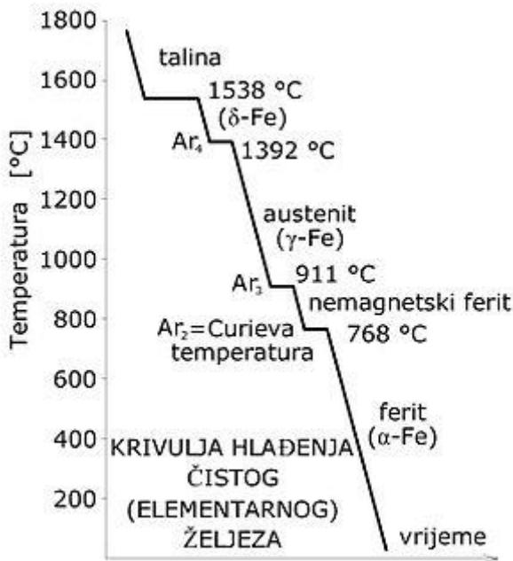
Slika 20. Krivulja hlađenja čistog (elementarnog ) željeza
