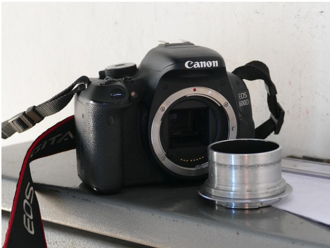
Slika 3. Fotoaparat i adapter za teleskop
