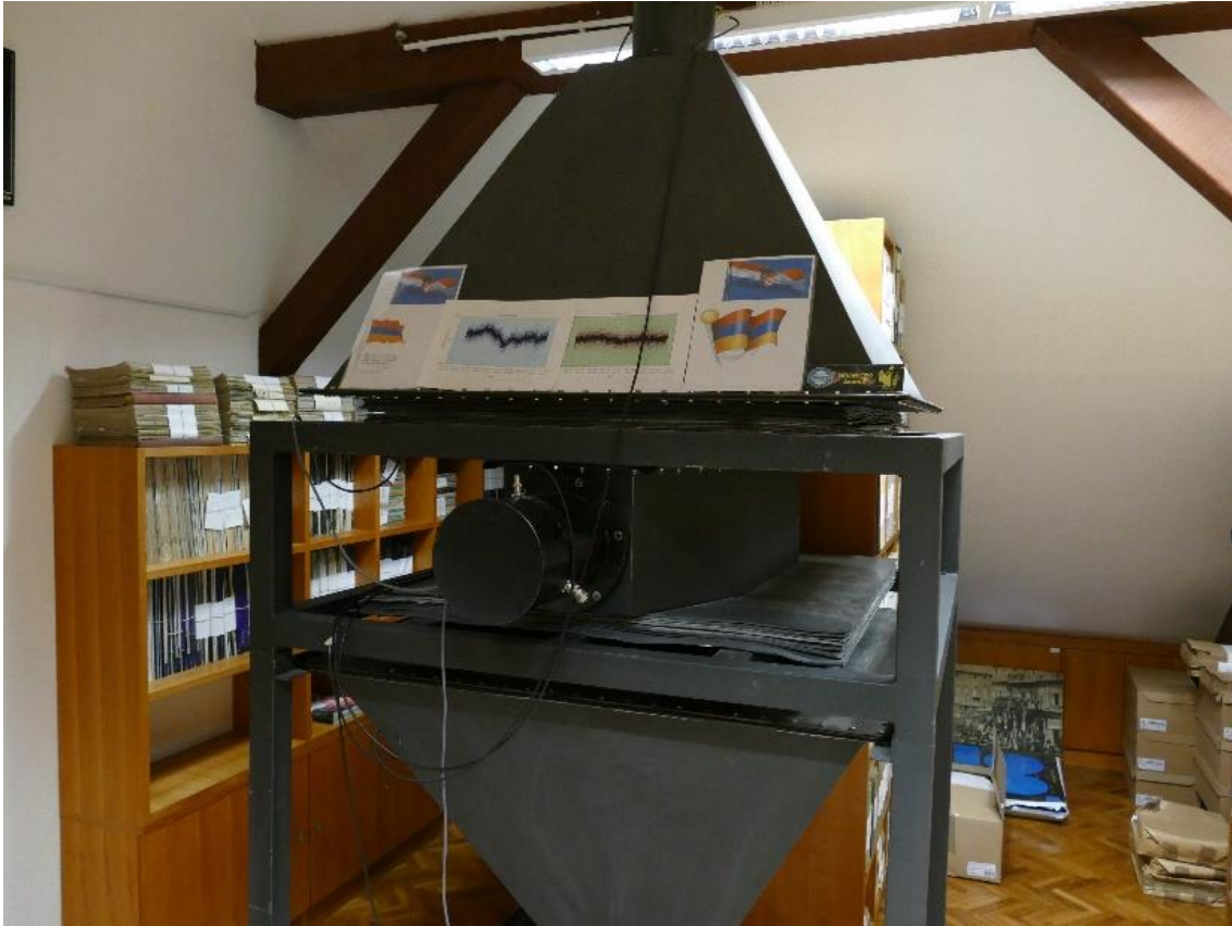
Slika 1. Detektor kozmičkog zračenja u Zagrebačkoj zvezdarnici
