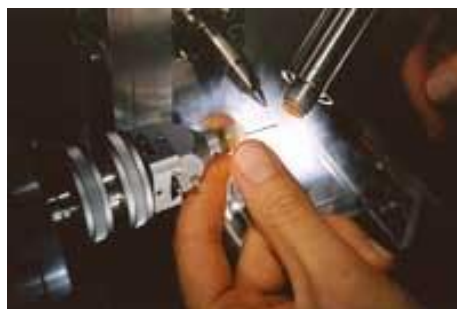
Slika 22. Postavljanje kristala na goniometrijsku glavu rentgenskog difraktometra.
