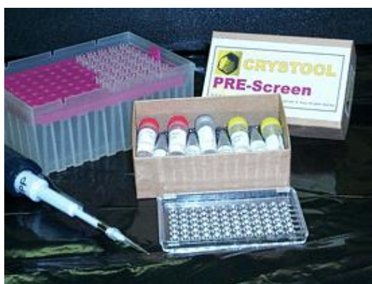
Slika 18. Primjer krita koji se koristi za provjeravanje odgovarajuće koncentracije proteina za eksperiment kristalizacije.
