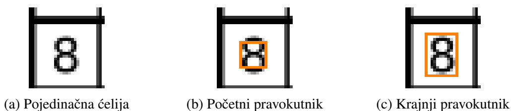
Slika 4.6: Detekcija znamenke unutar ćelije
