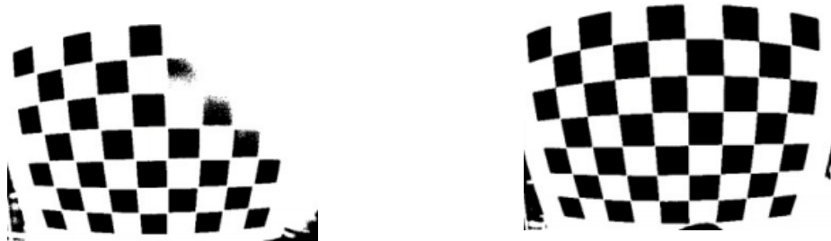
(a) Slika dobivena binarnim thresholdingom (b) Slika dobivena adaptivnim binarnim thresholdingom
