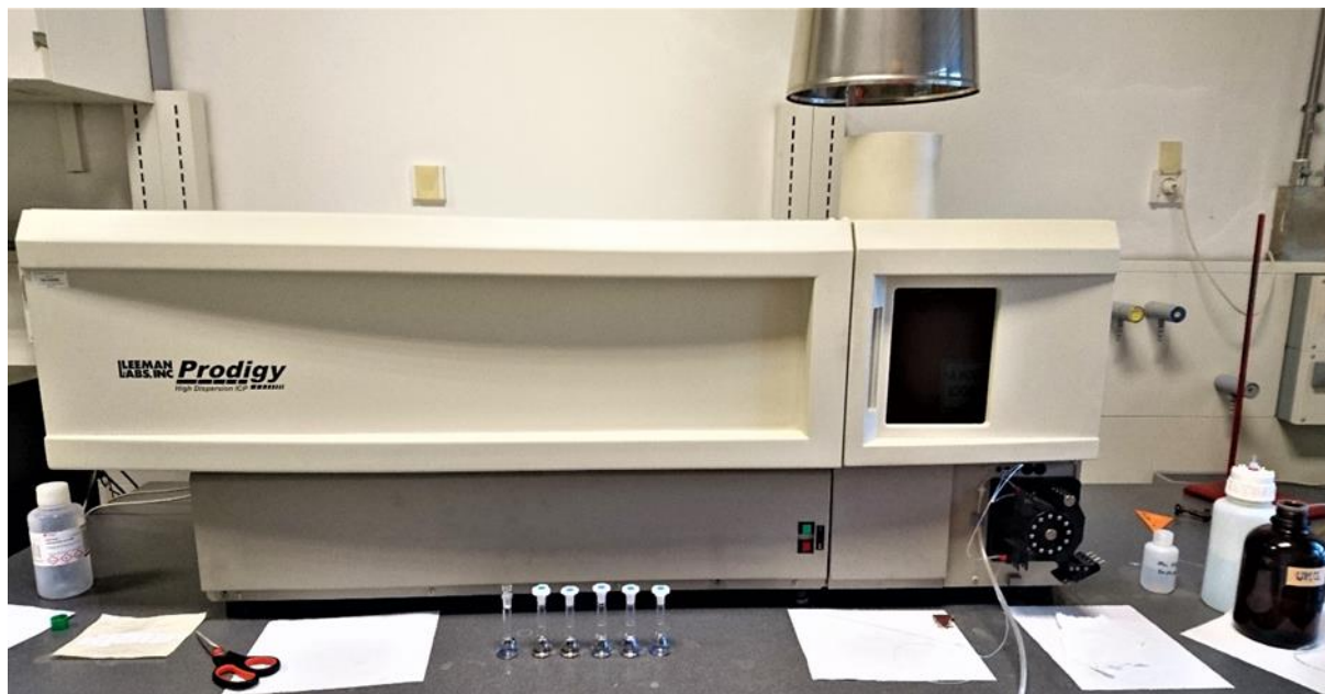
Slika 8. Optički emisijski spektrometar Prodigy High Dispersion ICP (Teledyne Leeman Labs, Hudson, NH, USA)
