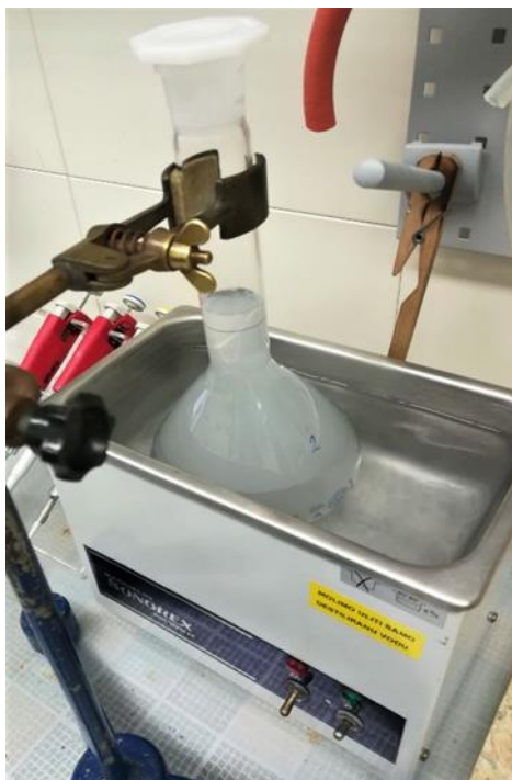
Slika 9. Homogenizacija 0,1 %-tne suspenzije \text{Al}_2\text{O}_3 i tirona
