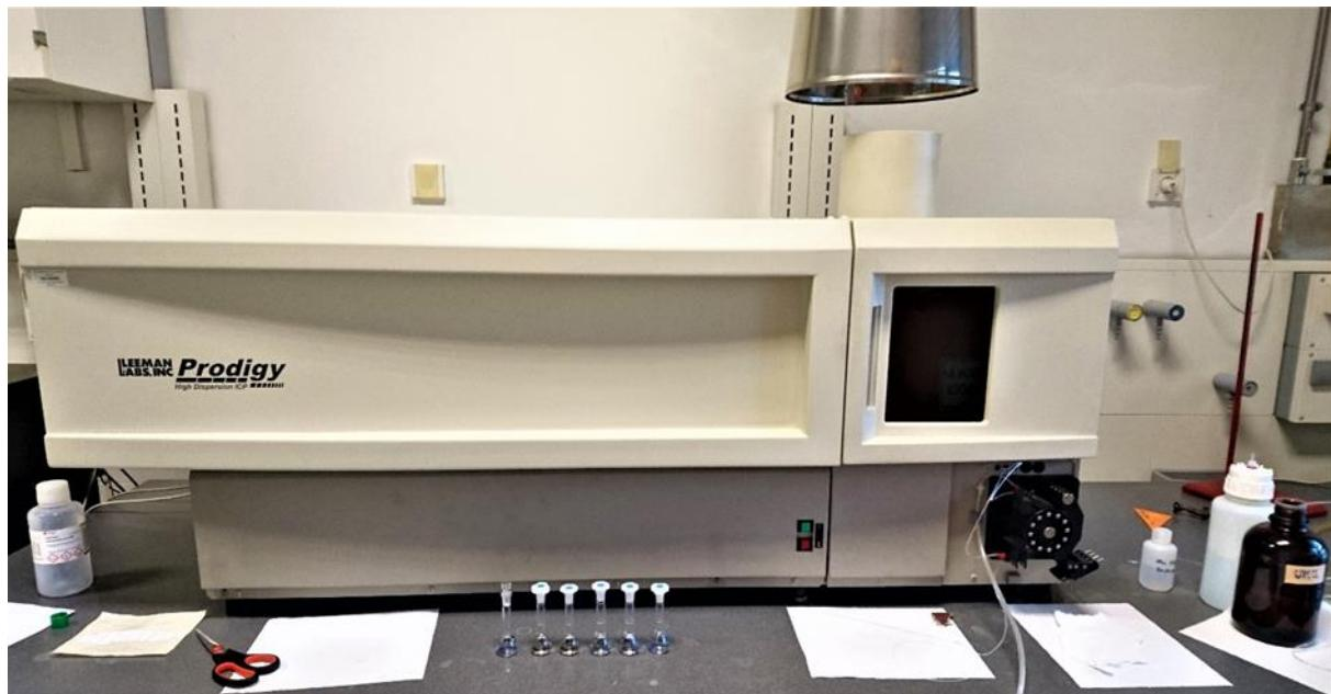
Slika 8. Optički emisijski spektrometar *Prodigy High Dispersion ICP*
