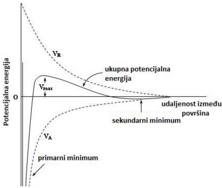
Slika 2. Shematski prikaz potencijala Van der Waalsoih privlačnih sila, potencijala elektrostatskih odbojnih sila, i njihova kombinacija kao funkcija udaljenosti od površine sferične čestice
