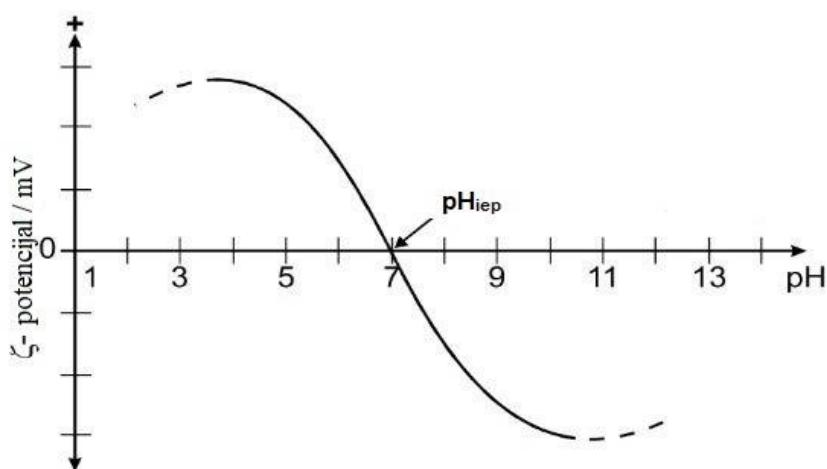
Slika 4.  $\zeta$  potencijal u ovisnosti o pH
