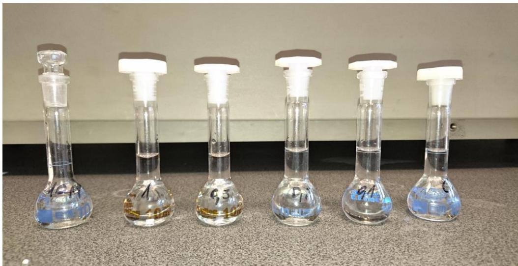
Slika 11. Multielementne standardne otopine
