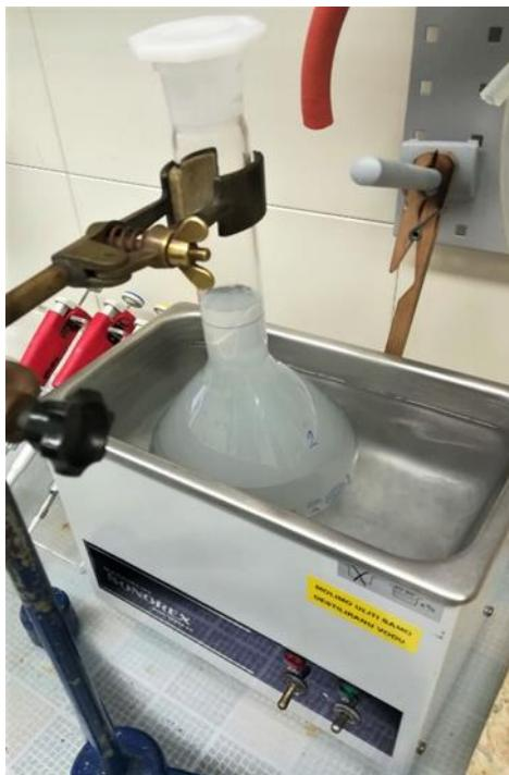
Slika 9. Homogenizacija 0,1 %-tne suspenzije  $\text{Al}_2\text{O}_3$  i tirona
