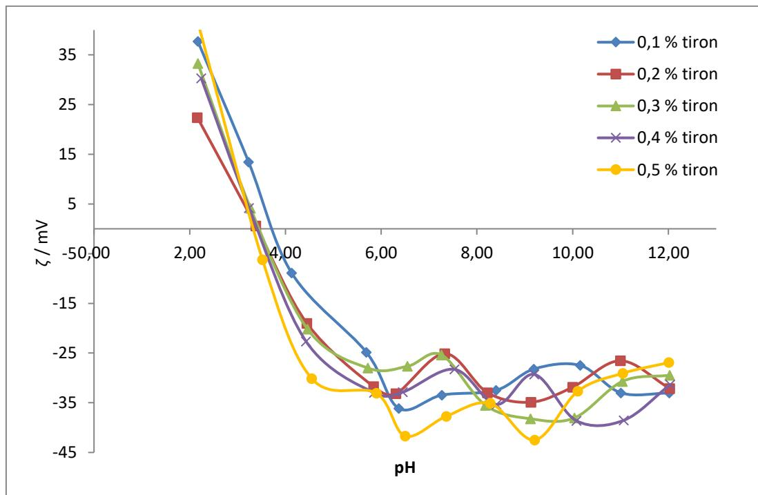
Slika 13. Ovisnost zeta potencijala ( $\zeta$ ) o pH vrijednostima 0,01 % w/v suspenzije  $\text{Al}_2\text{O}_3$  uz dodatak različitih udjela tirona pri 25 °C
