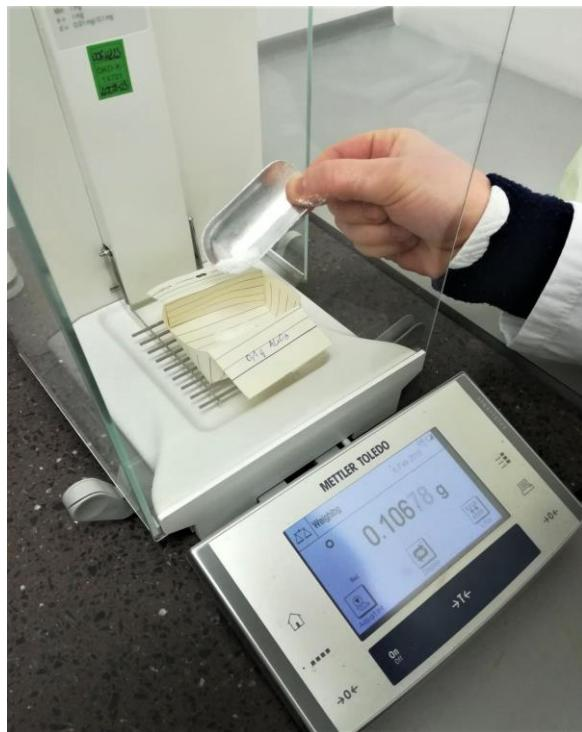
Slika 7. Analitička vaga (Mettler Toledo)
