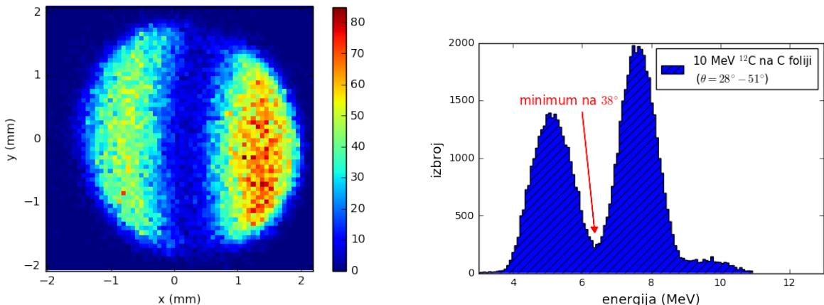
Slika 5.20: Raspodjela broja događaja u detektoru za raspršenje  $^{12}\text{C}^{3+}$  energije 10 MeV na C foliji debljine  $20 \mu\text{g}/\text{cm}^2$ .
