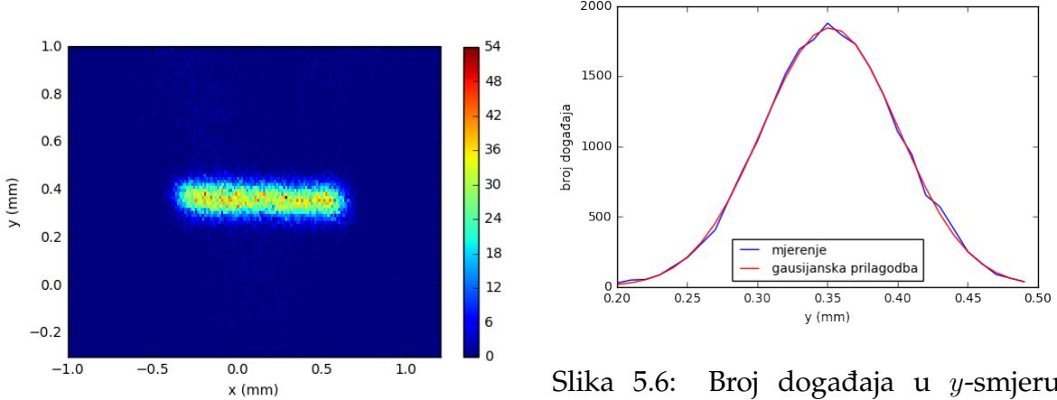
Slika 5.5: Raspodjela broja događaja - linijski sken u  $x$ -smjeru ( $835 \times 13 \mu\text{m}^2$ ) za određivanje rezolucije u  $y$ -smjeru.
