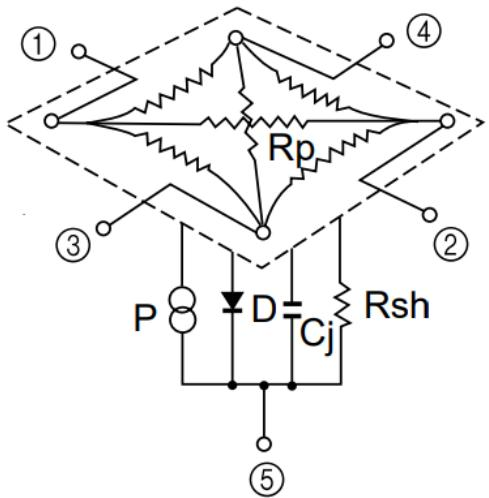
Slika 4.5: Shema ekvivalentnog strujnog kruga korištene PIN diode. Oznake: P = generator struje, D = idealna dioda, C<sub>j</sub> = kapacitet spoja, R<sub>sh</sub> = "shunt" otpornik, R<sub>p</sub> = pozicionirajući otpornik [13].
