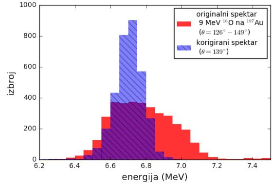
Slika 5.14: Usporedba izmјerenog spektra u rasponu kutova raspršenja s korigiranim spektrom za raspršenje  $^{16}\text{O}^{4+}$  energije 9 MeV na 10 nm  $^{197}\text{Au}$ .
