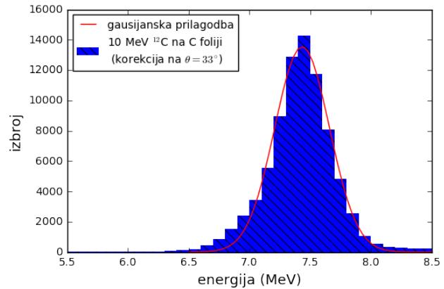
Slika 5.22: Korekcija izmјerenog spektra raspršenja  $^{12}\text{C}^{3+}$  energije 10 MeV na C foliji debljine  $20 \mu\text{g}/\text{cm}^2$  na piksel na kutu  $33^\circ$ .
