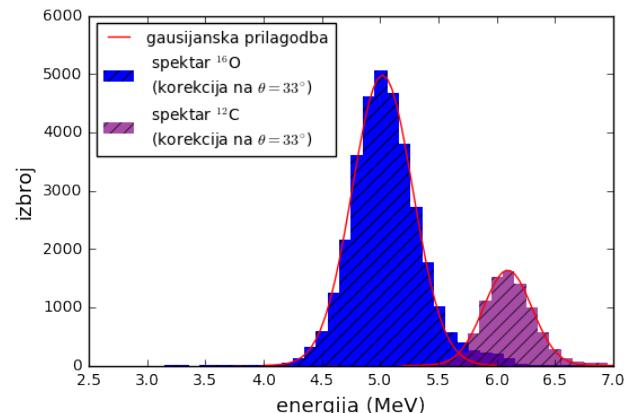
Slika 5.19: Korekcija izmjerenoj spektra raspršenja  $^{16}\text{O}^{4+}$  energije 9 MeV na C foliji debljine  $20 \mu\text{g}/\text{cm}^2$  na piksel na kutu  $33^\circ$ .
