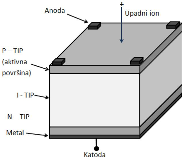
Slika 4.4: Skica 2D pozicijsko osjetljive PIN diode.
