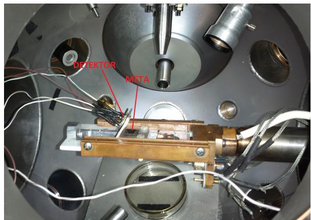
Slika 4.9: Fotografija postava u vakuumskoj komori prilikom mjerena raspršenja u stražnje kutove.
