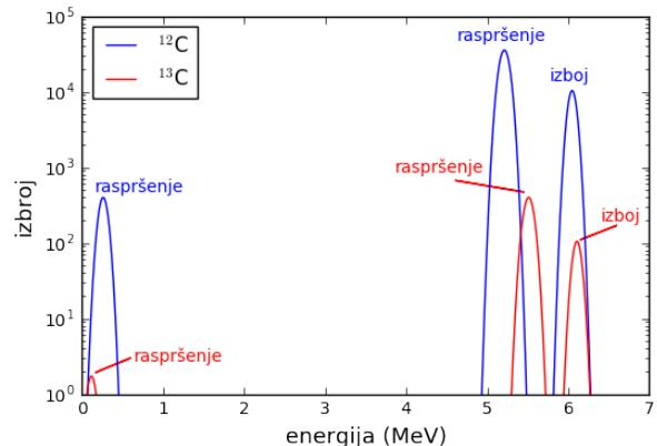
Slika 5.18: Spektar (log. skala) raspršenja  $^{16}\text{O}^{4+}$  energije 9 MeV na C foliji debljine  $20 \mu\text{g}/\text{cm}^2$  na kutu  $33^\circ$ , simuliran u programu SIMNRA.
