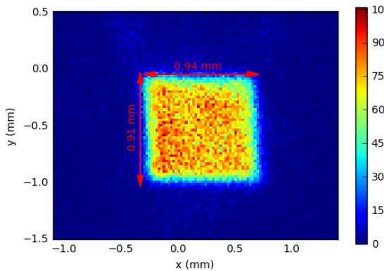
Slika 5.1: Raspodjela broja događaja - kvadratni sken ( $835 \times 835 \mu\text{m}^2$ ). Slika skeniranog područja je nešto veća ( $940 \times 910 \mu\text{m}^2$ ) zbog konačne prostorne rezolucije diode.
