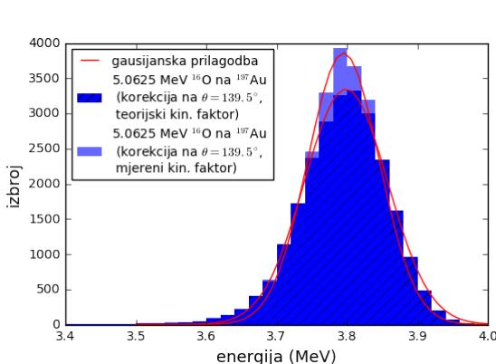
Slika 5.9: Korekcija izmјerenog spektra raspršenja  $^{16}\text{O}^{3+}$  energije 5.0625 MeV na 10 nm  $^{197}\text{Au}$  na piksel na kutu  $139.5^\circ$ .
