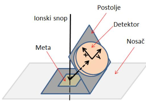
Slika 4.8: Shematski prikaz položaja diode i mete u vakuumskoj komori prilikom mjerena raspršenja u stražnje kutove.
