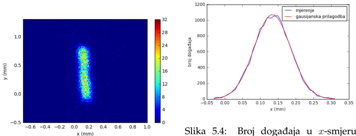
Slika 5.3: Raspodjela broja događaja - linijski sken u  $y$ -smjeru ( $13 \times 835 \mu\text{m}^2$ ) za određivanje rezolucije u  $x$ -smjeru.
