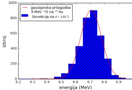
Slika 5.13: Korekcija izmјerenog spektra raspršenja  $^{16}\text{O}^{4+}$  energije 9 MeV na 10 nm  $^{197}\text{Au}$  na piksel na kutu  $139^\circ$ .
