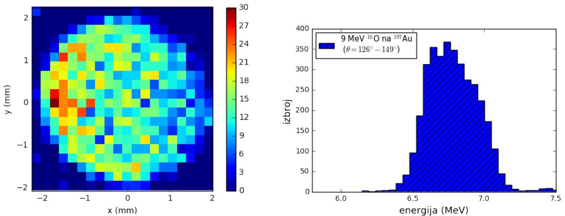
Slika 5.11: Raspodjela broja događaja u detektoru za raspršenje  $^{16}\text{O}^{4+}$  energije 9 MeV na 10 nm  $^{197}\text{Au}$ .
