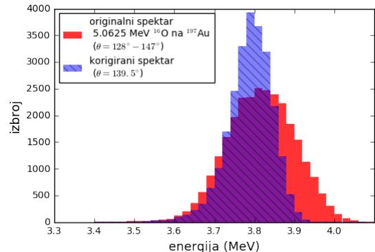
Slika 5.10: Usporedba izmјerenog spektra u rasponu kutova raspršenja s korektiranim spektrom za raspršenje  $^{16}\text{O}^{3+}$  energije 5.0625 MeV na 10 nm  $^{197}\text{Au}$ .
