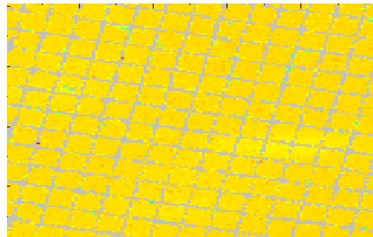
Slika 4.7: Slika mrežice u detektoru (400 zareza po inču) iz koje je određena veličina skeniranog područja.
