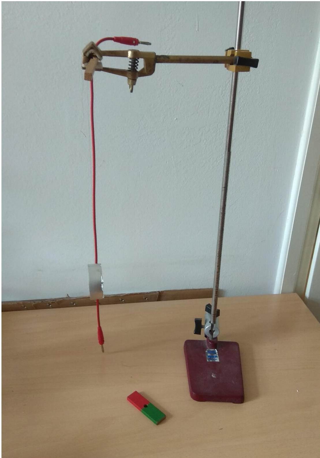
Slika 3.13. Složeni eksperimentalni postav za demonstraciju Lenzovog pravila
