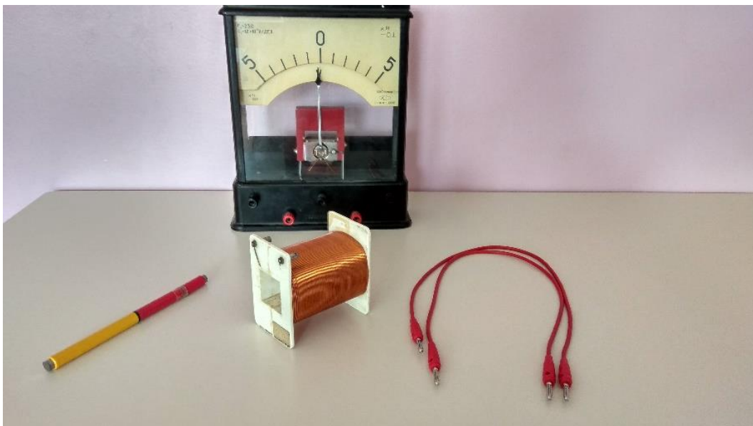
Slika 3.7. Eksperimentalni postav za ispitivanje pojave elektromagnetske indukcije
